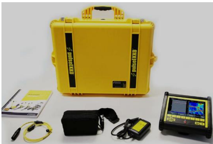
Εικόνα 1.3.1 (Εξοπλισμός pulseEKKO για διασκοπήσεις γεωραντάρ)
