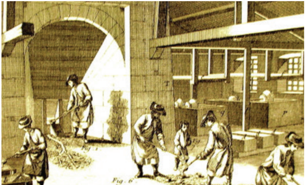
Εικ.1: Χαρακτικό του 18ου αιώνα που απεικονίζει ένα χυτήριο σιδήρου όπου σιδερένια μαγειρικά σκεύη κατασκευάζονται σε καλούπια από άμμο.
