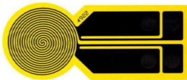
Εικόνα 3.2.1.1: Αισθητήρας Hot Disk με μόνωση Kapton
