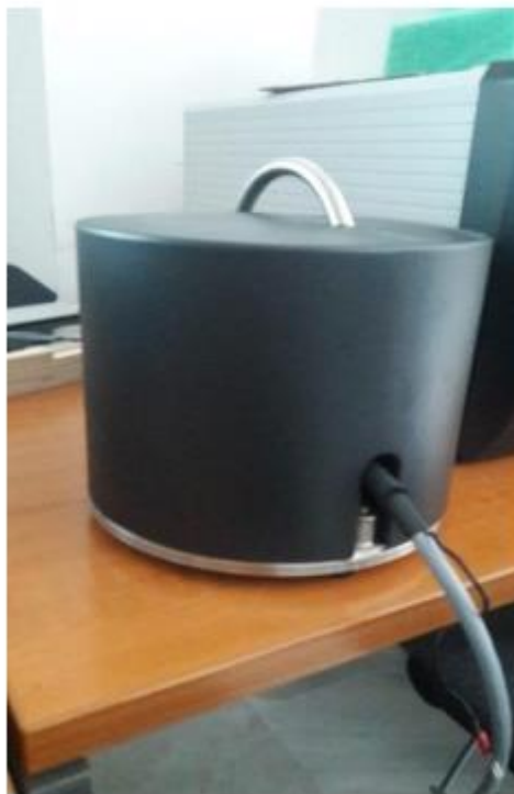
Εικόνα 3.2.1.4: Προστατευτικό περίβλημα υποστηρικτή δείγματος για μετρήσεις σε θερμοκρασία δωματίου
