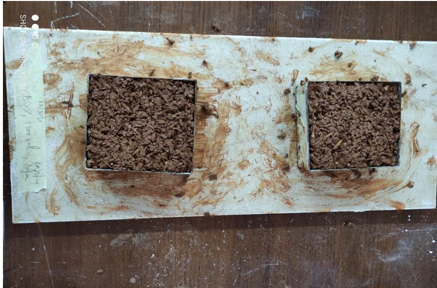
Εικόνα 3.1.1.1: Ομογενοποιημένο μείγμα μέσα στο καλούπι
