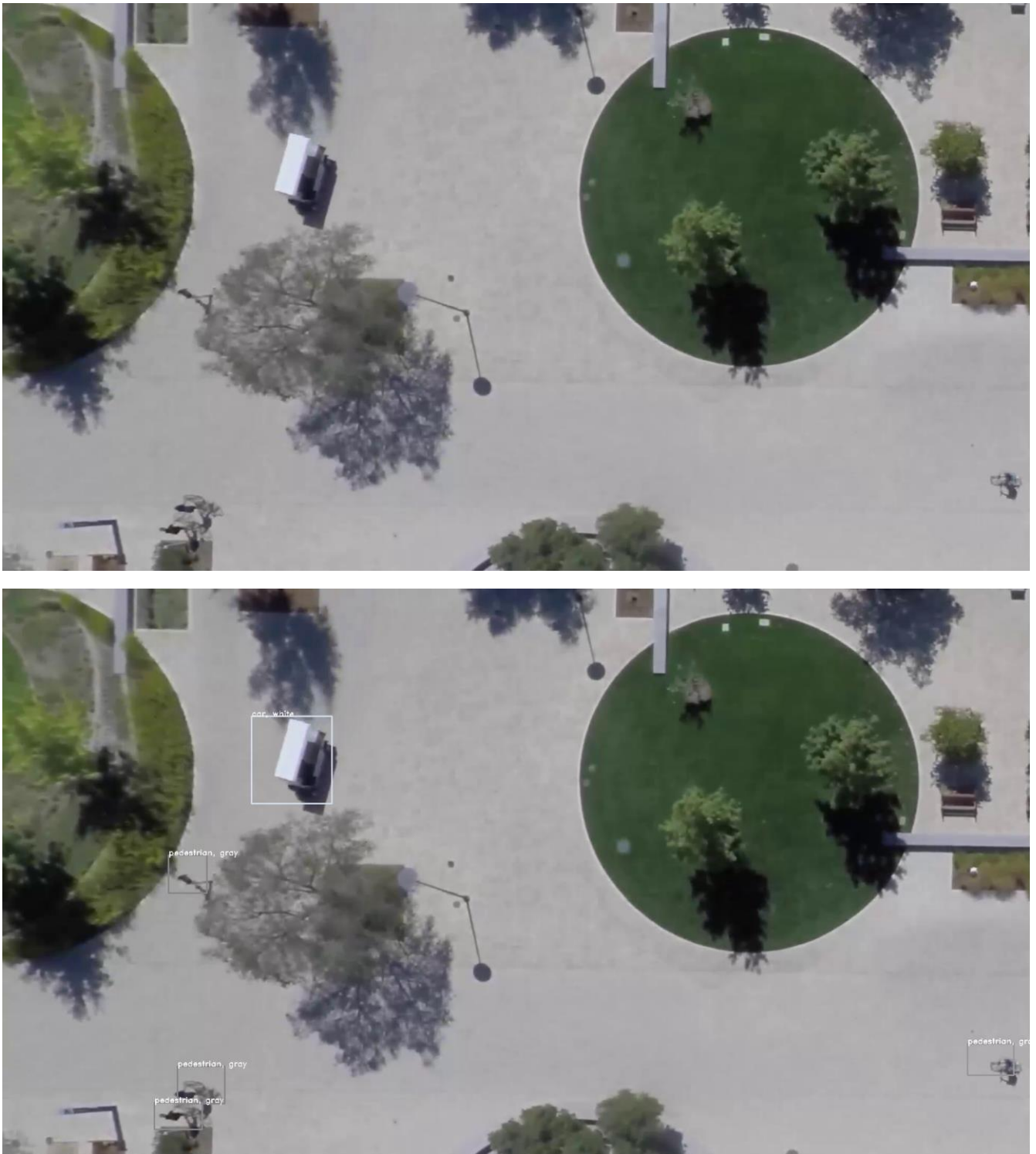
Εικόνα 8.6. Περίπτωση 2 - Αναγνώριση των αντικειμένων και εντοπισμός χρώματος χρησιμοποιώντας το μοντέλο YOLOv5x και GrabCut. Αρχική εικόνα (Πάνω) και εικόνα με τα αναγνωρισμένα αντικείμενα σε πλαίσιο περιμετρικά καθώς και το εντοπισμένο χρώμα (Κάτω).
