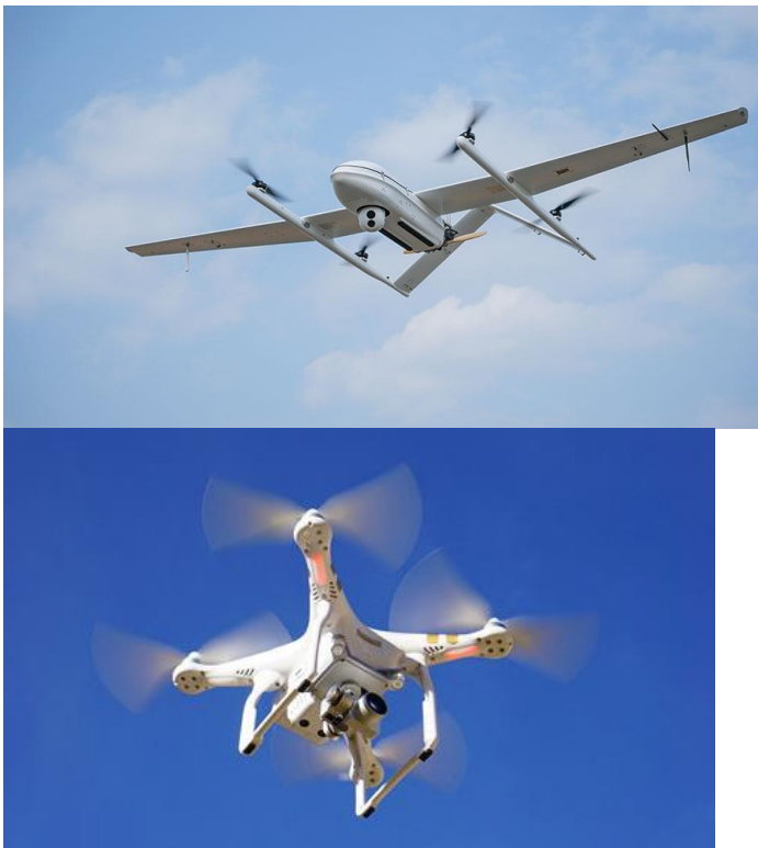
Εικόνα 2.3. Παραδείγματα μη επανδρωμένων ιπτάμενων αντικειμένων (UAVs): Αριστερά, αεροσκάφος σταθερών πτερύγων και δεξιά, τετρακόπτερο (quadcopter).
