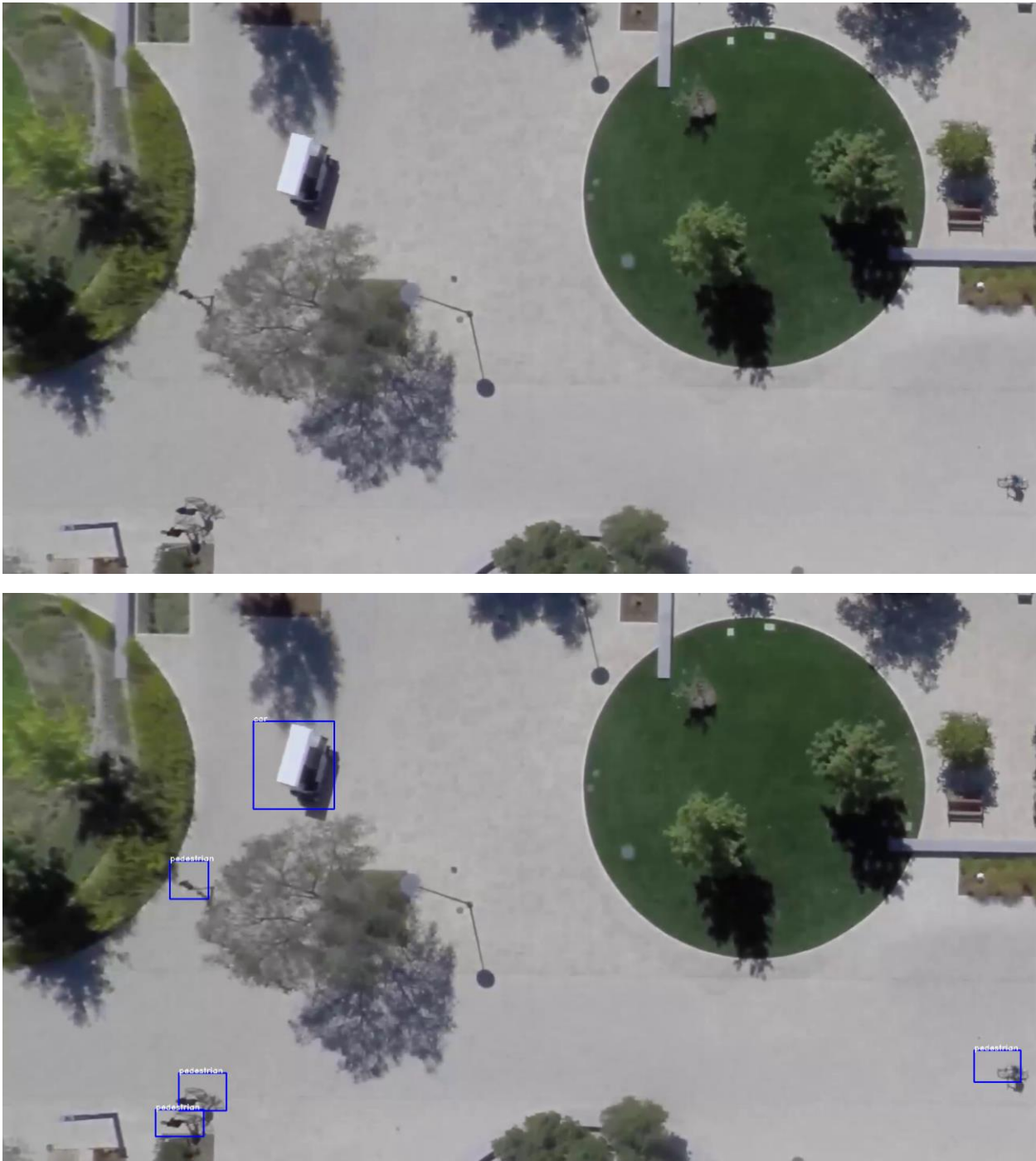
Εικόνα 7.14. Περίπτωση 2 - Αναγνώριση των αντικειμένων με χρήση του αρχικού μοντέλου YOLOv5x. Αρχική φωτογραφία (Πάνω) και φωτογραφία με τα αναγνωρισμένα αντικείμενα σε πλαίσια μπλε χρώματος (Κάτω).
