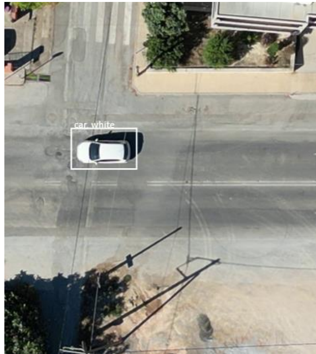
Εικόνα 8.10. Αναγνώριση αντικειμένων (αυτοκίνητο) και εντοπισμός χρώματος σε φωτογραφία από UAV του εργαστηρίου «Εργαστήριο Ψηφιακής Επεξεργασίας Σήματος και Εικόνas» του Πολυτεχνείου Κρήτης.
