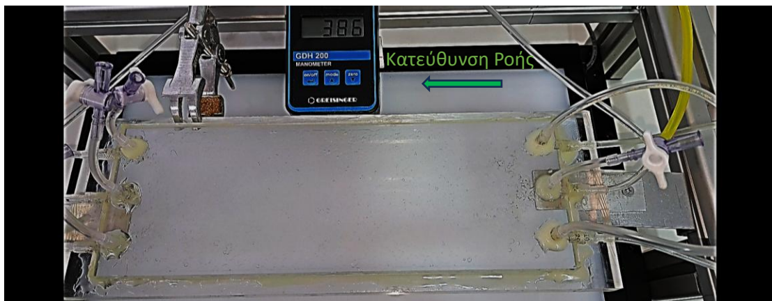
Εικόνα 26: (41 sec , 387 Pa) ή (41 sec , 384,59 Pa) Το σημείο όπου εισέρχεται ο αέρας
