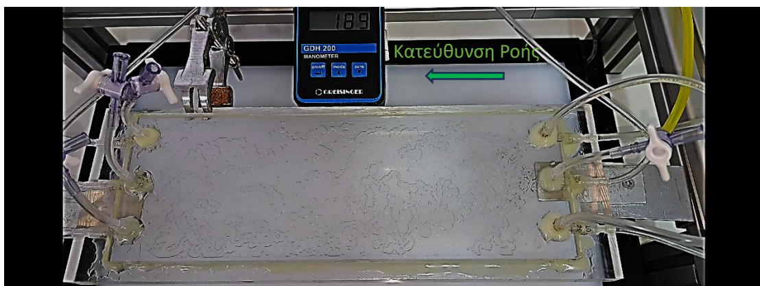
Εικόνα 27: (55 sec , 189 Pa) (55sec , 187,59 Pa) Το σημείο όπου γίνεται το break through
