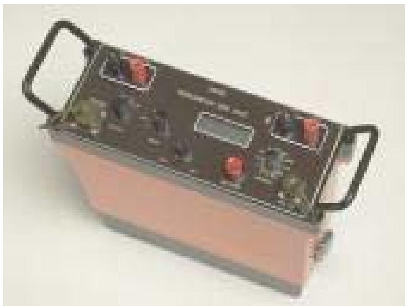
Σχήμα 4.3. Η συσκευή ABEM Terrameter που περιέχει πηγή ρεύματος, αμπερόμετρο και βολτόμετρο
