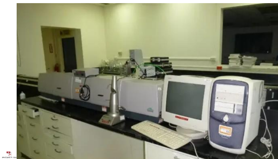
Εικόνα 12: Συσκευή κοκκομετρικής ανάλυσης με περίθλαση ακτινών Laser ( www.fedequip.com ).
