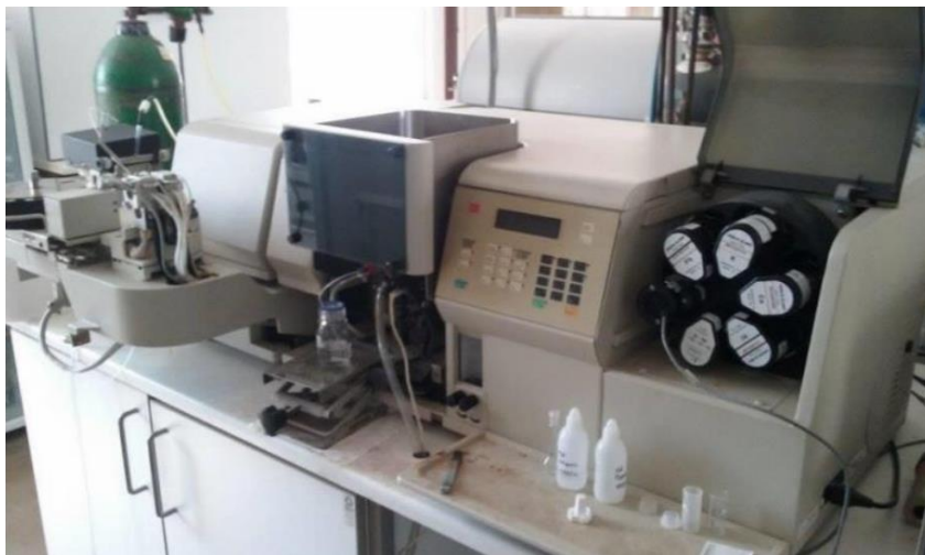
Εικόνα 17: Φασματοφωτόμετρο Ατομικής Απορρόφησης εργαστηρίου Γεωχημείας.
