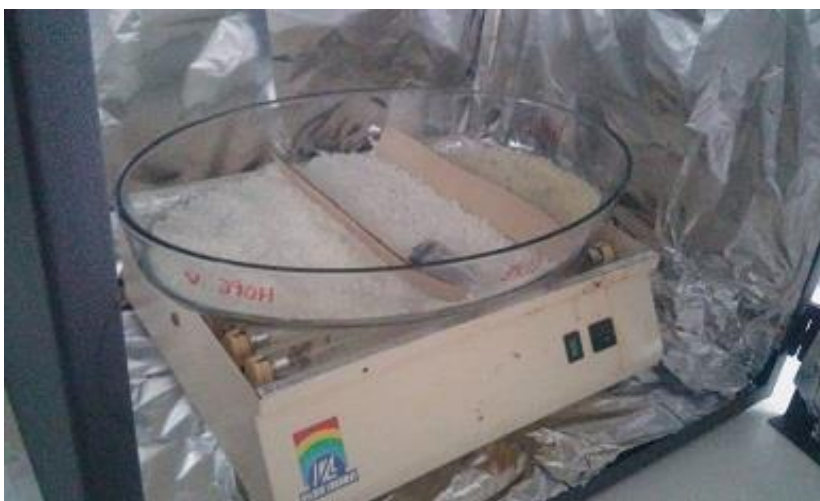
Εικόνα 13 Pellets HDPE σε UV-A ακτινοβολίας.
