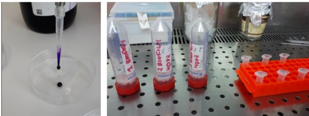
Εικόνα 17: (Αριστερά) Χρώση δειγμάτων με κρυσταλλικό ιώδες. (Δεξιά) Τέλος δειγματοληψίας – Τοποθέτηση βιοφίλμ σε falcon και Errendorf για μελλοντικές αναλύσεις.
