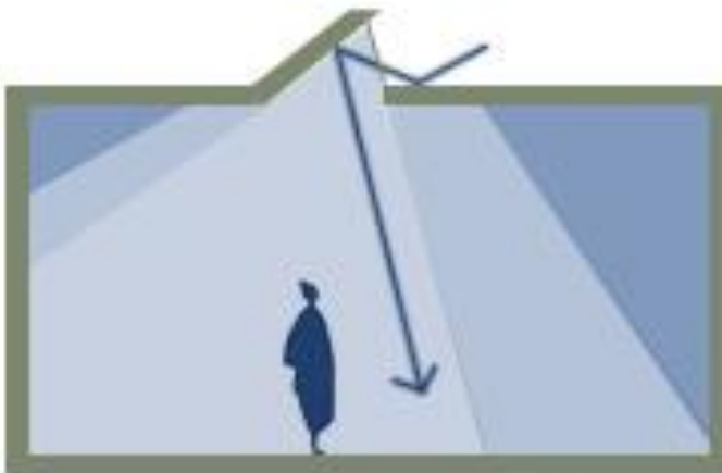
Διάγραμμα 5 : Είσοδος του φυσικού φωτός μέσω ανακλαστήρων
