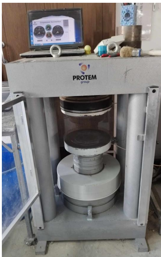
Εικόνα 4.12: Σερβοϋδραυλική πρέσα PROTEM που χρησιμοποιήθηκε για την θραύση των δοκιμών
