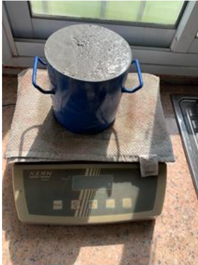
Εικόνα 3.6: Ζύγισμα μήτρας μετά την συμπύκνωση για την εύρεση πυκνότητας
