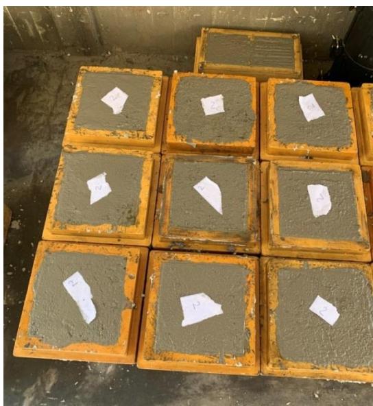
Εικόνα 3.7: Κυβικά καλούπια αμέσως μετά την δειγματοληψία
