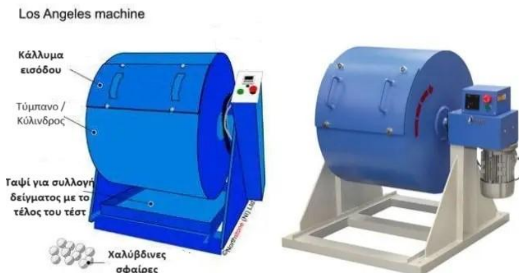
Εικόνα 2.11: Μηχάνημα Λος Άντζελες και τα μέρη του (Mishra, 2016)
