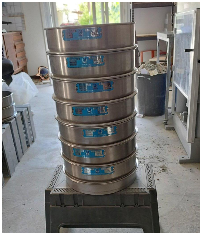
Εικόνα 2.7: Κόσκινα για την κοκκομετρική διαβάθμιση
