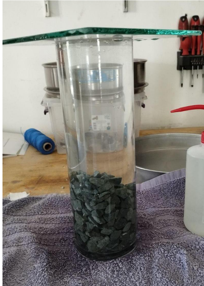
Εικόνα 2.10: Δοκιμή εύρεσης ειδικού βάρους
