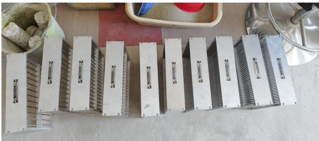
Εικόνα 2.8: Κόσκινα που χρησιμοποιήθηκαν για τον υπολογισμό του δείκτη πλακοειδούς
