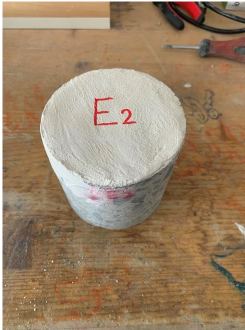
Εικόνα 4.7: Πυρήνας μετά το καπέλωμα (κονία επιπεδώσεως)
