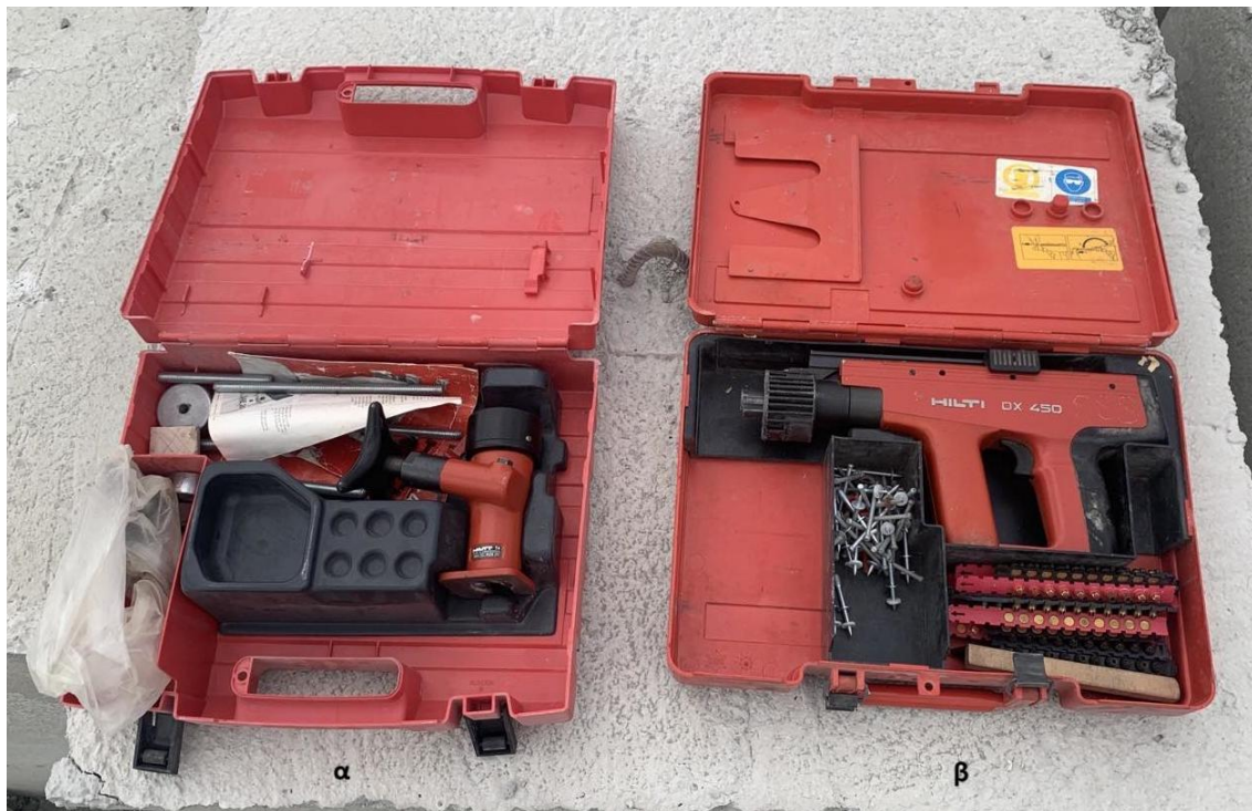
Εικόνα 4.2: α) Στο αριστερό μέρος το εργαλείο εξαγωγής και μέτρησης της αντίστασης και β) δεξιά το μηχάνημα Hilti για την εισαγωγή των καρφιών στο σκυρόδεμα στα δεξιά
