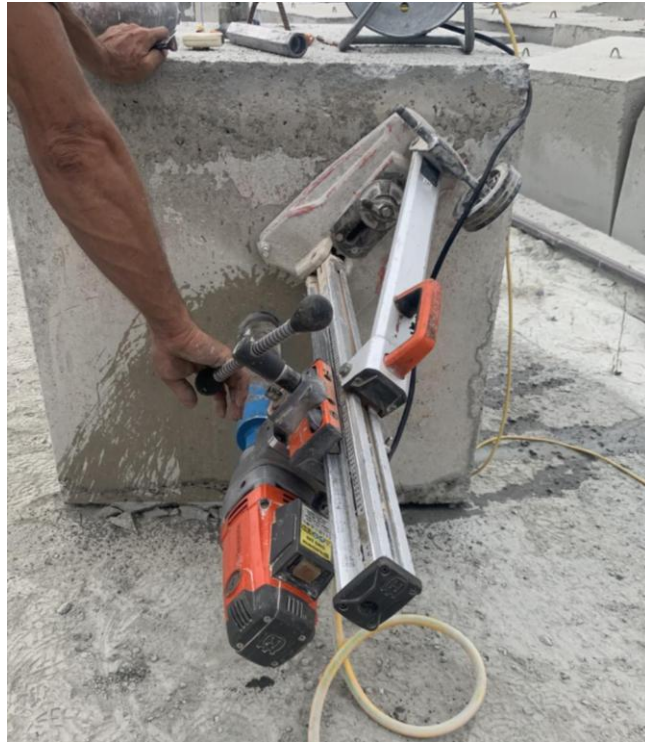
Εικόνα 4.4: Μηχανή Husqvarna DMS240 πυρηνοληψίας καρότων κατά την διάρκεια της δειγματοληψίας
