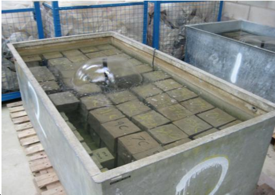
Εικόνα 3.8: Δοκίμια σε συνθήκες 100% κορεσμού στο εργαστήριο
