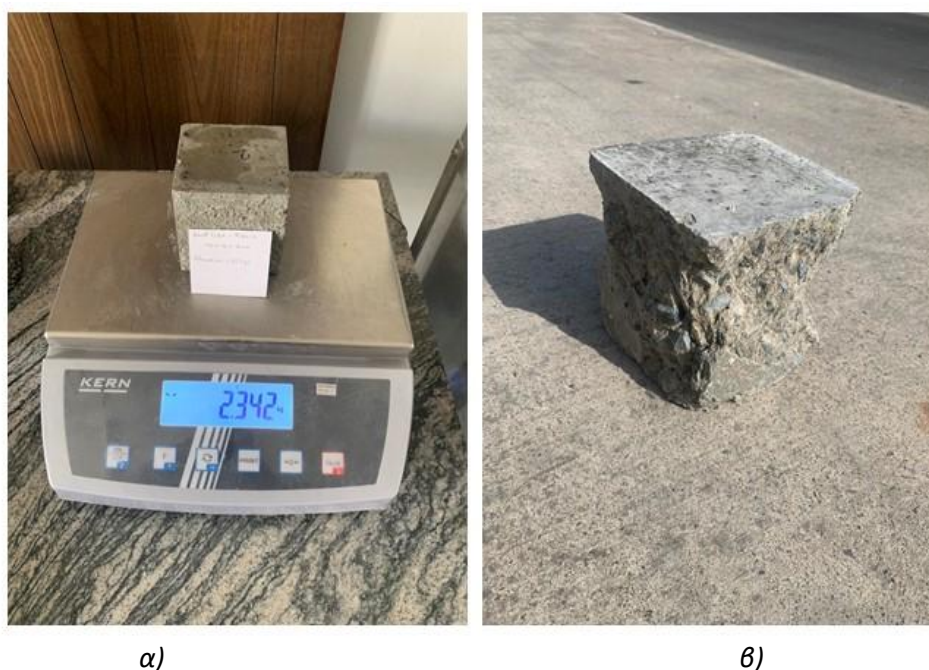
Εικόνα 4.14: α) δοκίμιο κατά την διαδικασία μέτρησης του βάρους του και β)κυβικό δοκίμιο μετά την θραύση.
