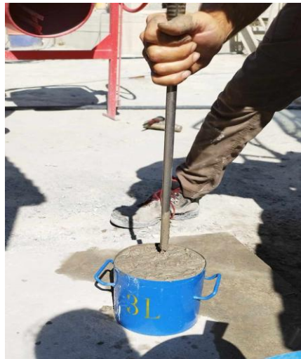
Εικόνα 3.5: Διαδικασία συμπίκνωσης σκυροδέματος για τον προσδιορισμό της πυκνότητας του σκυροδέματος
