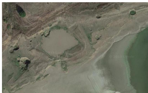
Εικόνα 4.14: Λεπτομερής εικόνα αριστερού αντερείσματος με απεικόνιση των χαρακτηριστικών καρστικών βυθισμάτων ( www.earth.google.com )
