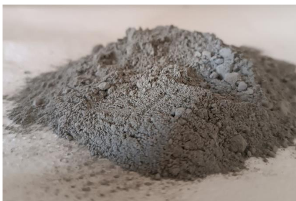
Εικόνα 3.1: Πυριτικά τέλματα επίπλευσης μετά από λειοτρίβηση.
