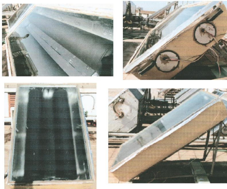
Εικόνα 1.4: ICS σύστημα με συμμετρικό παραβολικό κάτοπτρο και δύο δεξαμενές νερού χρήσης σε σειρά [45].
