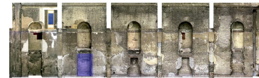
Διάγραμμα 11: Σχέδια και αποτύπωση καταστροφών και επεμβάσεις συμπλήρωσεις υλικού
