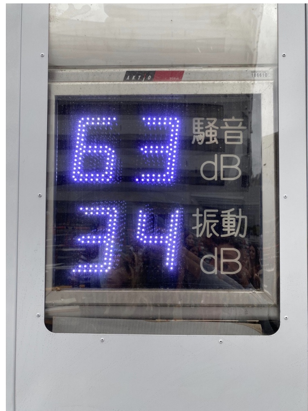
Εικόνα 34, Ντεσιμπελόμετρο έξω από εργοτάξιο στο Τόκυο
