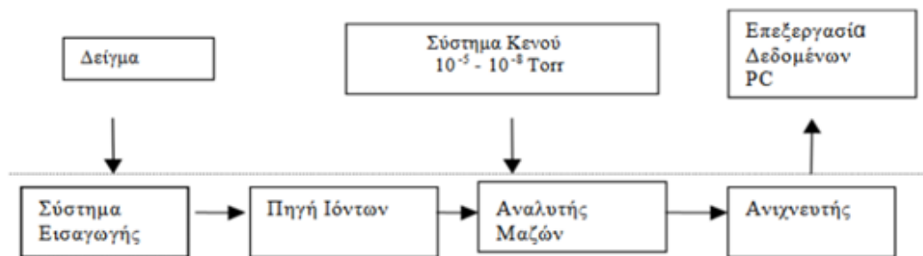
Εικόνα 2.3 Σχηματική αναπαράσταση των τμημάτων του φασματογράφου μαζών
