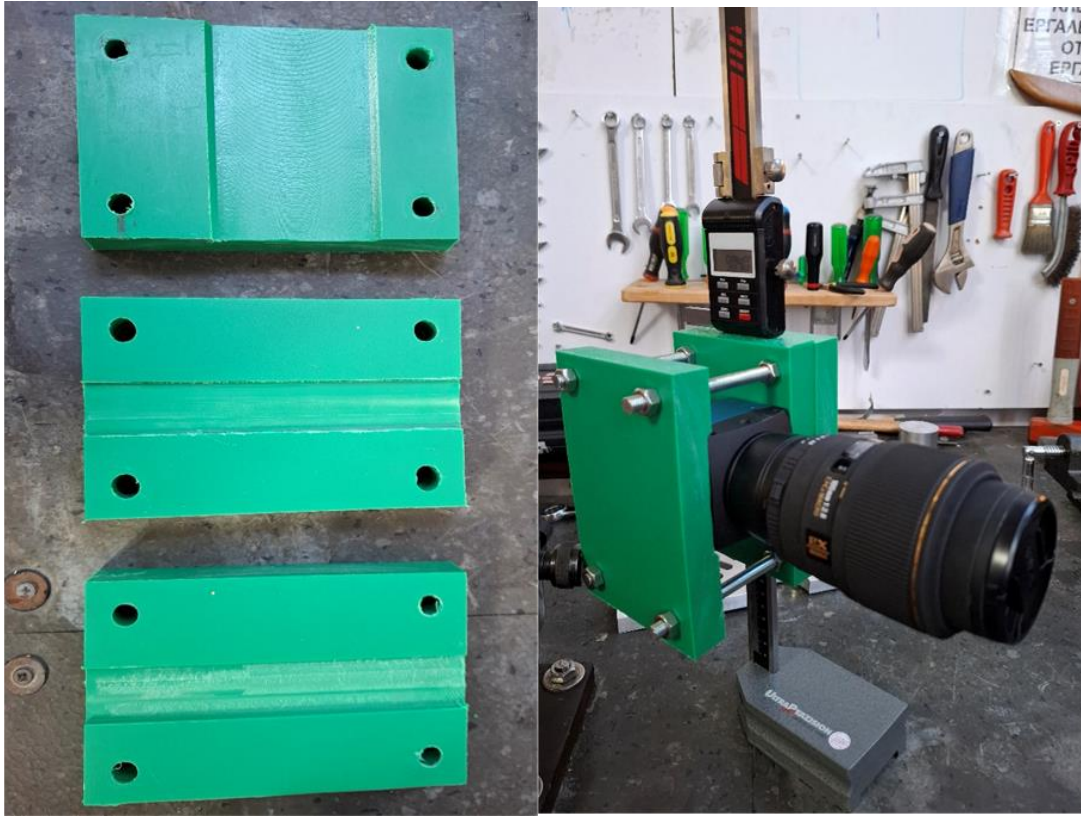
Σχήμα 3.11. Αριστερά τα πλακάκια που χρησιμοποιήθηκαν για τη βάση συγκράτησης και δεξιά η συναρμολόγησή της
