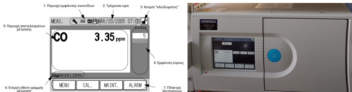
Σχήμα 3.8: Οθόνη μετρήσεων του οργάνου APMA-370 (αναπροσαρμοσμένο από Ambient CO monitor APMA-370, Operation Manual, 2009) (αριστερά), APMA-370 στον σταθμό των Χανίων (δεξιά).
