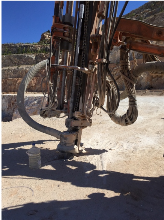
Εικόνα 3.4 Διαδικασία διάτρησης με Tamrock CHA 1100.
