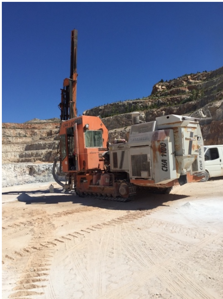
Εικόνα 3.3 Διατρητικό μηχάνημα Tamrock CHA 1100.
