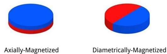
Εικόνα 61. Διαφορά μαγνητικού πεδίου αξονικού και διαμετρικού μαγνητισμού.
