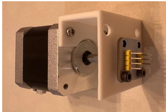
Εικόνα 63. Ο αισθητήρας τοποθετημένος στο μοτέρ.
