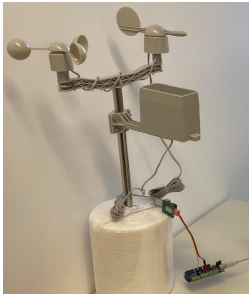
Εικόνα 51. Η πρώτη έκδοση του μετεωρολογικού σταθμού.
