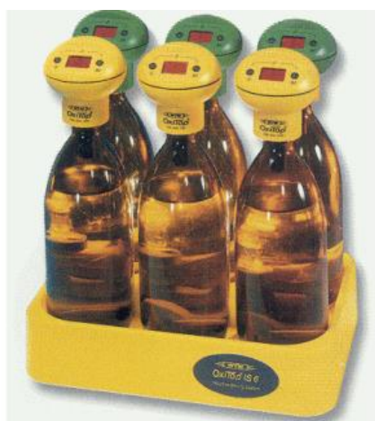
Εικόνα 41: Φιάλες BOD με ειδικά πώματα OxiTop, τοποθετημένες σε σύστημα μαγνητικού αναδευτήρα (Παντίδου, Α. και Αντέλλη, Κ., 2019)
