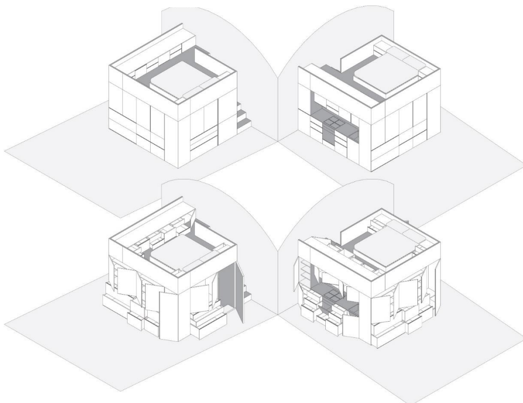
Εικόνα 77: Αξονομετρικές απεικονίσεις της σύνδεσης/κύβου από δυο διαφορετικές γωνίες θέασης. Στα πάνω σχέδια η σύνδεση έχει τους αποθηκευτικούς χώρους κλειστούς ενώ στα κάτω ανοιχτούς.
