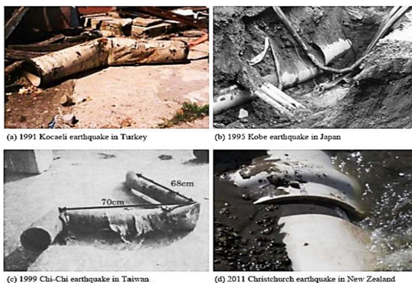
Εικόνα 2.16: Αστοχίες αγωγών μετά από σεισμό, (Raveshi and Noorzad (2023)).
