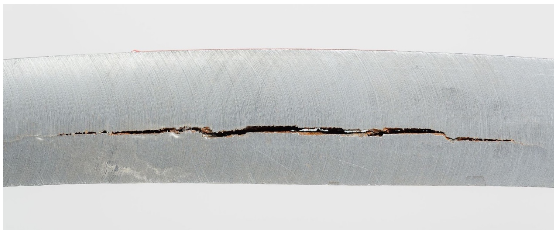
Εικόνα 2.2: Ρωγμή αγωγού λόγω ψαθυροποίησης, (Demaco Cryogenics, 2021).
