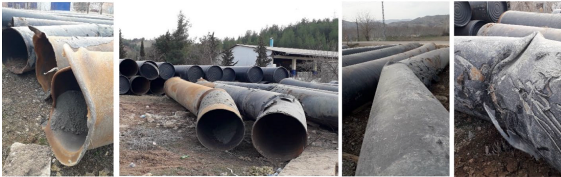
Εικόνα 2.18: Αγωγοί φυσικού αερίου μετά από διασταύρωση με ρήγμα μετά από τον σεισμό στην Τουρκία το 2023, (Uçkan, Aksel, Atas, Toprak, and Kaya, 2024).
