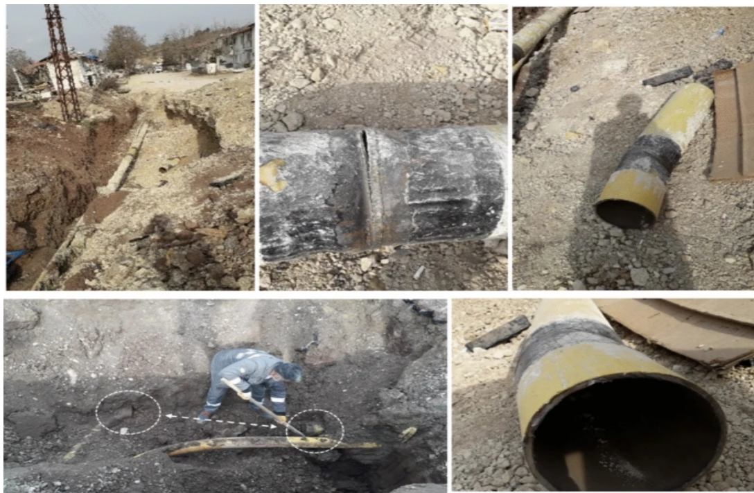
Εικόνα 2.19 Αστοχία αγωγών λόγω ρευστοποίησης του εδάφους στο Γκιούλμπασι, (Uçkan, Aksel, Atas, Toprak, and Kaya, 2024).
