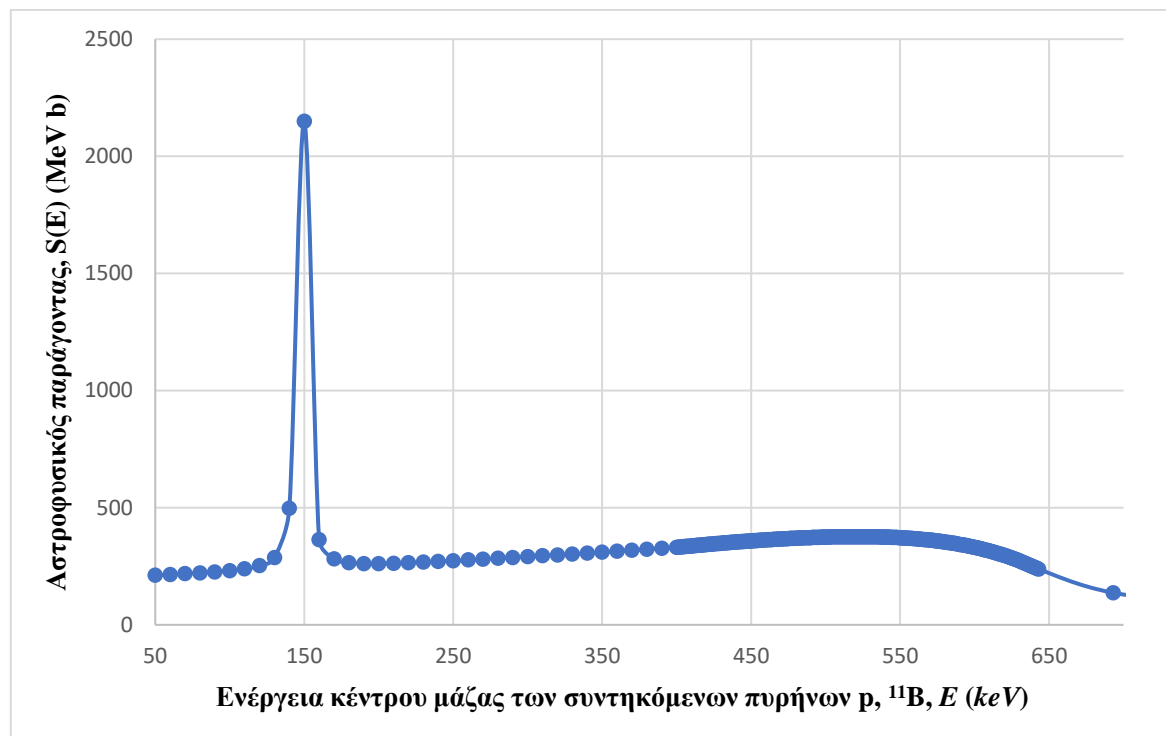
Σχήμα 2. 3: Εξέλιξη του αστροφυσικού παράγοντα, S(E) , των M. H. Sikora - R. Weller [18], σαν συνάρτηση της ενέργειας κέντρου μάζας ( 50 \text{ keV} \leq E \leq 700 \text{ keV} ) των συντηκόμενων πυρήνων p , ^{11}\text{B} .
