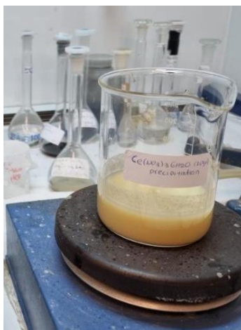
Εικόνα 26 Διάλυμα \text{Ce}(\text{NO}_3)_3 \cdot 6\text{H}_2\text{O} , για τη σύνθεση \text{CeO}_2 με τη μέθοδο της συγκαταβύθισης.
