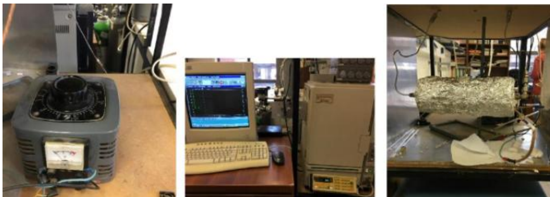
Εικόνα 33 Αντιδραστήρας και σύστημα ανάλυσης αποτελεσμάτων (α) ρυθμιστής θερμοκρασίας (β) αέριος χρωματογράφος (Shimadzu GC-14B) συνδεδεμένος με Η/Υ και (γ) φούρνος με αντιδραστήρα.
