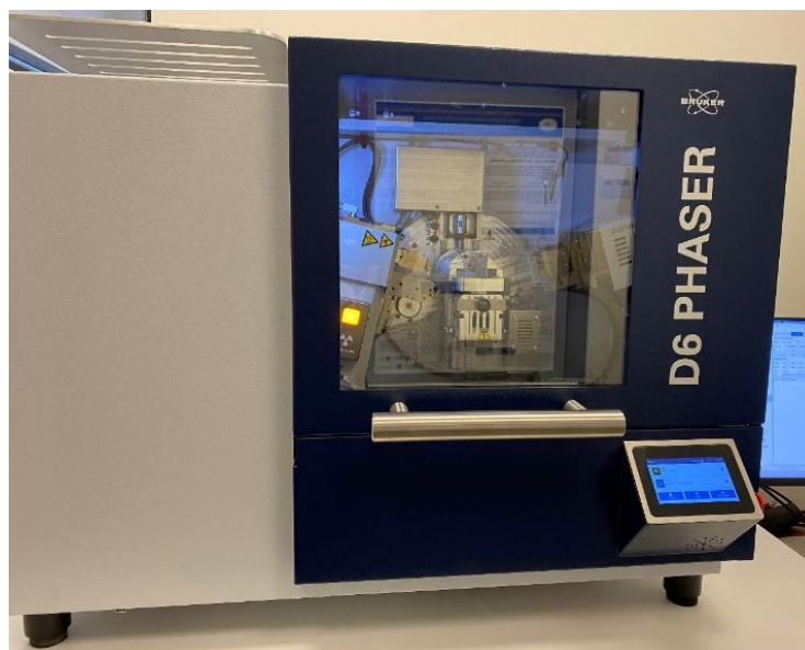
Εικόνα 29 Περιθλασίμετρο D6 Phaser της εταιρείας Bruker.
