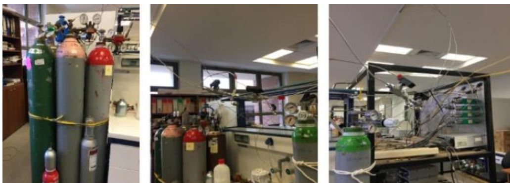
Εικόνα 34 Σύστημα τροφοδοσίας: (α) φιάλες αερίων τροφοδοσίας, (β) βαλβίδες και ροόμετρα μάζας συνδεδεμένα με τις φιάλες των αερίων, (γ) βαλβίδες και ροόμετρα μάζας συνδεδεμένα με τον αντιδραστήρα και το χρωματογράφο.
