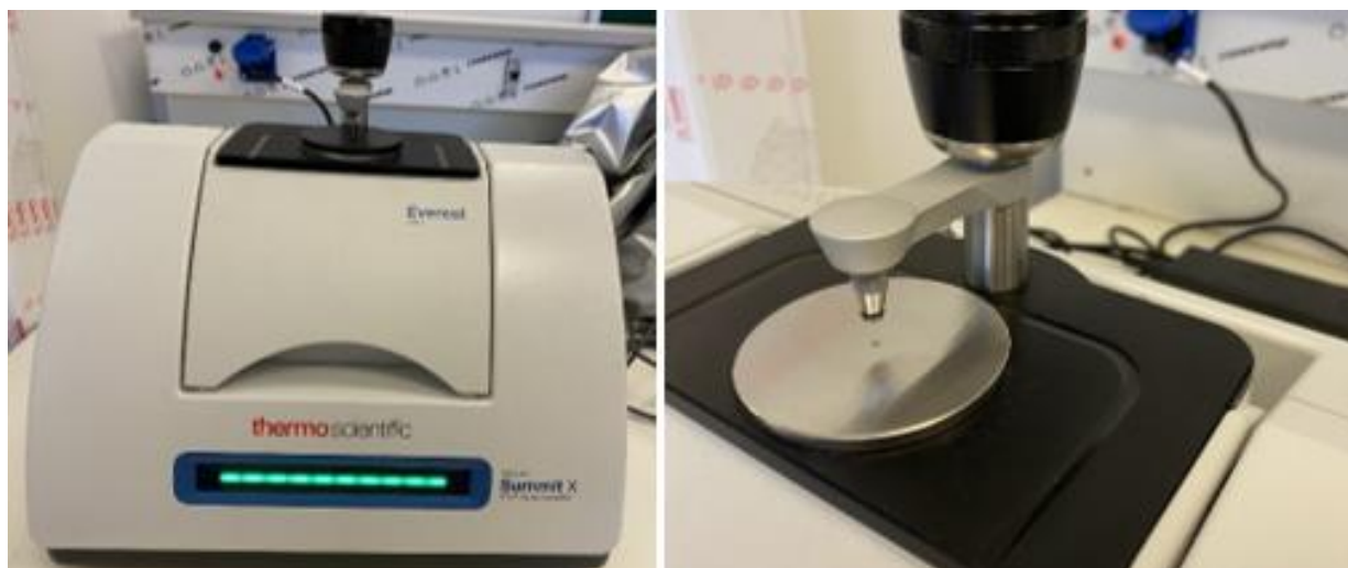
Εικόνα 31 Φασματοόμετρο Nicolet, SummitX της εταιρείας ThermoScientific.
