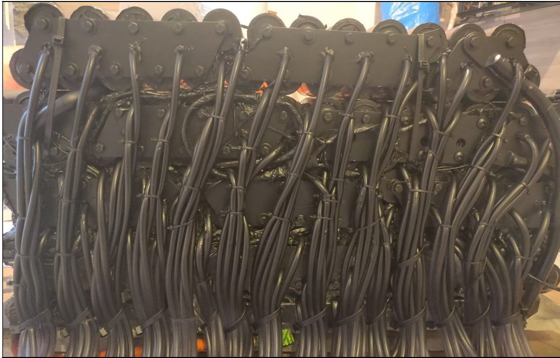
Εικόνα 43. Πραγματική απεικόνιση της Συστοιχίας Α' αφού έχει γίνει διάστρωση με γομοειδής μονωτική επικάλυψη. (πίσω πλευρά)
