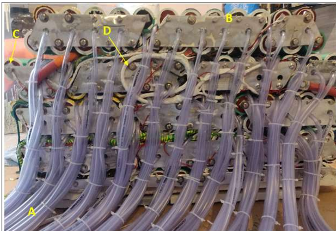
Εικόνα 41. Πραγματική απεικόνιση της Συστοιχίας Α' πριν γίνει διάστρωση με γομοειδής μονωτική επικάλυψη
