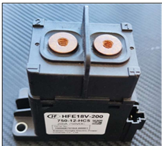
Εικόνα 67. Ρελέ ισχύος με ενσωματωμένη ασφάλεια 200A.
