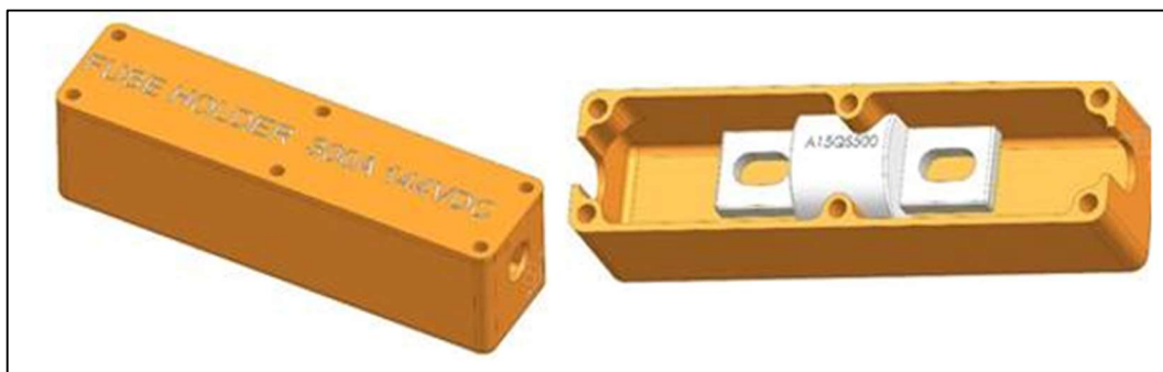
Εικόνα 63. 3D απεικόνιση ηλεκτρολογικού κουτιού γενικής ασφάλειας υψηλής τάσης.
