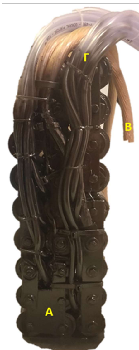
Εικόνα 56. Πραγματική απεικόνιση της Συστοιχίας Γ' αφού έχει γίνει διάστρωση με γομοειδής μονωτική επικάλυψη [Δεξιά πλευρά]
