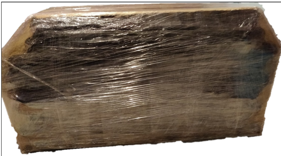
Εικόνα 44. Πραγματική απεικόνιση της Συστοιχίας Α' αφού έχει τοποθετηθεί το σύμμικτο περίβλημα περιμετρικά των κελιών. Η συστοιχία έχει περιτυλιχθεί με λεπτή αντιστατική μεμβράνη, η οποία βοηθά στην διαδικασία διάστρωσης ενισχυτικών υφασμάτων.
