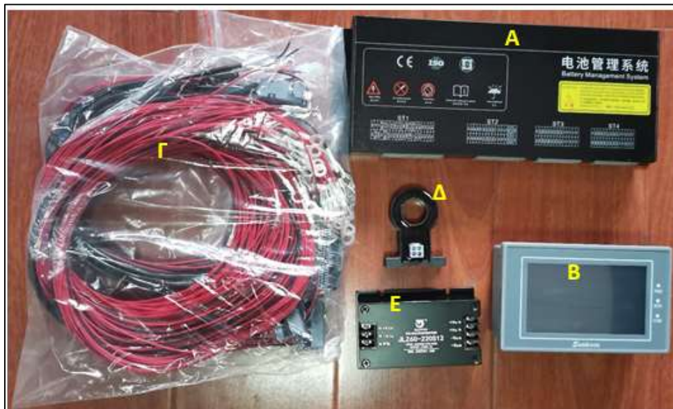
Εικόνα 75. Φωτογραφία του BMS και των περιφερειακών εξαρτημάτων του.
