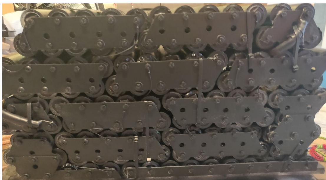
Εικόνα 42. Πραγματική απεικόνιση της Συστοιχίας Α' αφού έχει γίνει διάστρωση με γομοειδής μονωτική επικάλυψη. (πίσω πλευρά)
