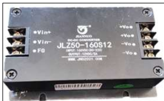
Εικόνα 84. DC – DC Converter (120W) για συστήματα μικρής κατανάλωσης, Μετατροπέας συνεχούς τάσης
