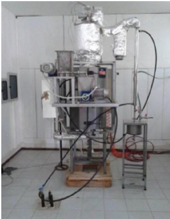
Εικόνα 3.1 Ρευστοποιημένη κλίνη
