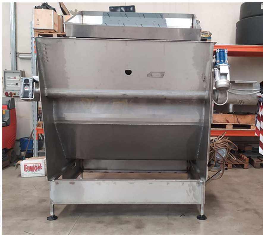
Σχήμα 5.7: Φωτογραφίες κατά την κατασκευή του μικροκόσκινου.
