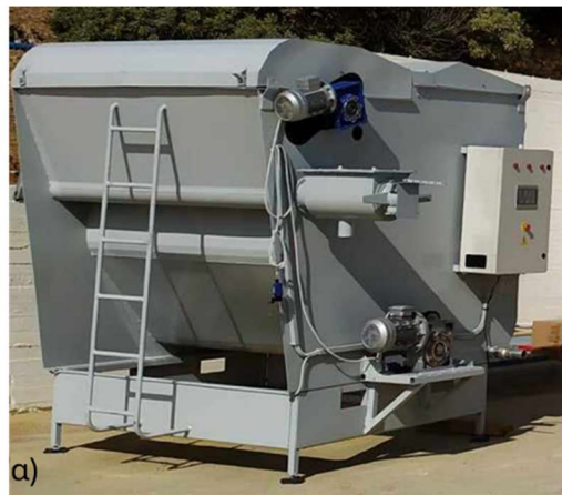
Σχήμα 2.9: α) Φωτογραφία μικροκόσκινου (τύπου RBF) που κατασκεύασε το εργαστήριο Σχεδιασμού Περιβαλλοντικών Διεργασιών, Πολυτεχνείου Κρήτης στην ΕΕΛ Μάρπησσας, β) Σχηματική απεικόνιση RBF (Franchi et al., 2012).
