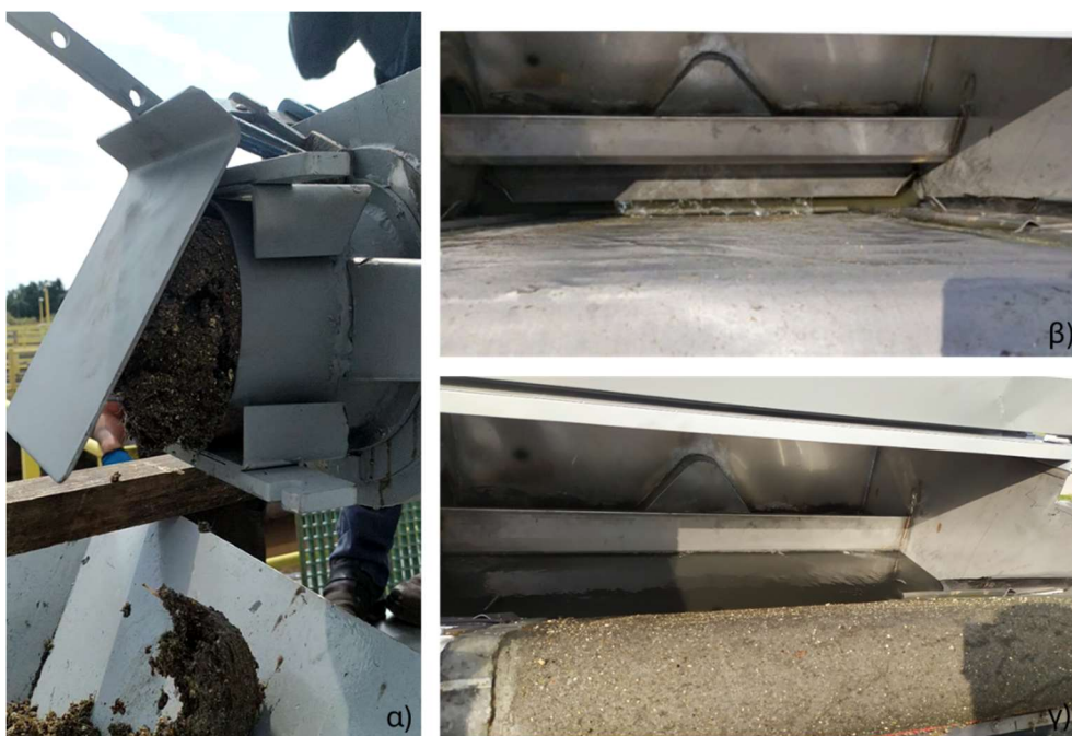
Σχήμα 6.5: α) Παραγόμενα βιοστερεά, β) εσωτερικό τμήμα του μικροκόσκινου γ) σχηματισμός υμένα.
