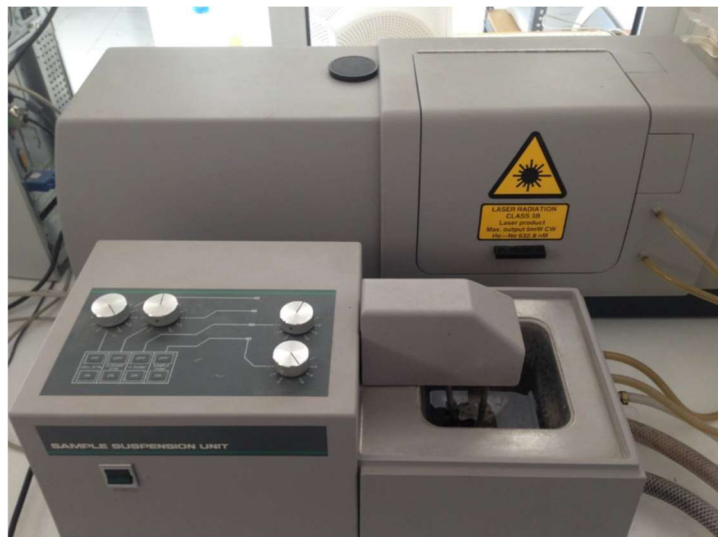
Σχήμα 6.1: Όργανο μέτρησης διαμέτρων σωματιδίων- Malvern Mastersizer 2000.
