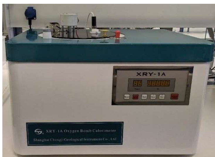
Σχήμα 6.3: Θερμιδόμετρο-XRY-1A Digital Oxygen Bomb Calorimeter.
