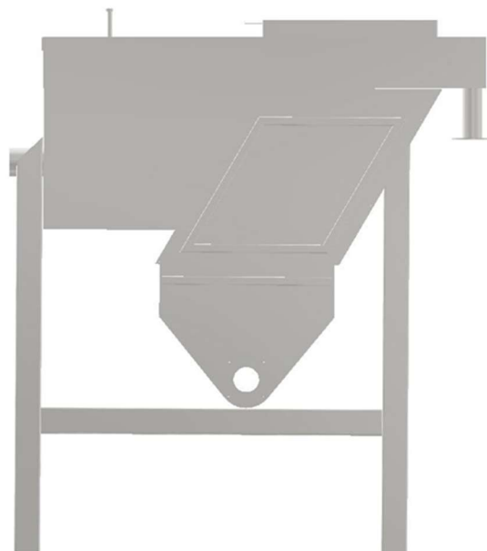
Σχήμα 5.4: Φωτογραφία της δεξαμενής καθίζησης με λαμέλλες που σχεδιάστηκε και κατασκευάστηκε από το εργαστήριο Σχεδιασμού Περιβαλλοντικών Διεργασιών του Πολυτεχνείου Κρήτης στην ΕΕΛ Μάρπησσας β) σχηματική απεικόνιση της δεξαμενής κατά τον σχεδιασμό.
