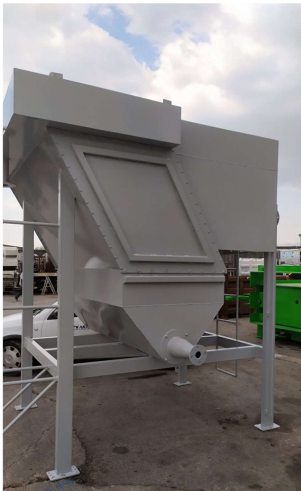
Σχήμα 5.9: Φωτογραφίες κατά την κατασκευή της δεξαμενής καθίζησης με λαμέλλες.
