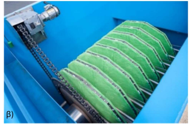
Σχήμα 2.10: (α) Φωτογραφία ενός CDF στην ΕΕΛ Linda, Καλιφόρνια, Ηνωμένες Πολιτείες Αμερικής, (β) Οκτώ μεμονωμένοι δίσκοι στο εσωτερικού του CDF (Caliskaner et al., 2018).
