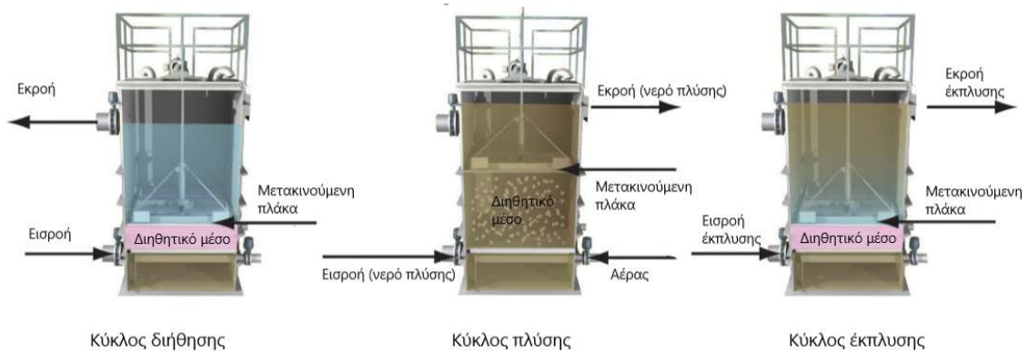
Σχήμα 2.15: Σχηματική απεικόνιση των κύκλων διήθησης, πλύσης και έκπλυσης του CMF (Fitzpatrick et al., 2011).
