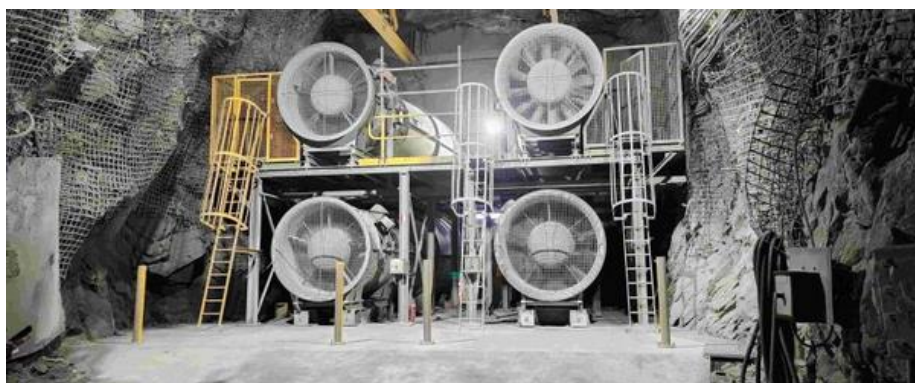
Σχήμα 5-5: Εμπρόσθια όψη μηχανικού αερισμού σε υπόγειο μεταλλείο ( https://sugercanes.com ).
