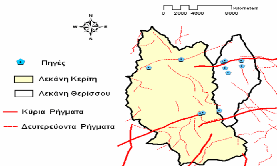
Χάρτης 3.9. Τα ρήγματα και οι πηγές εκφόρτισης των υπογείων υδάτων στις λεκάνες απορροής Κερίτη και Θερίσσου (Πηγή: Karatzas et al., 2010)
