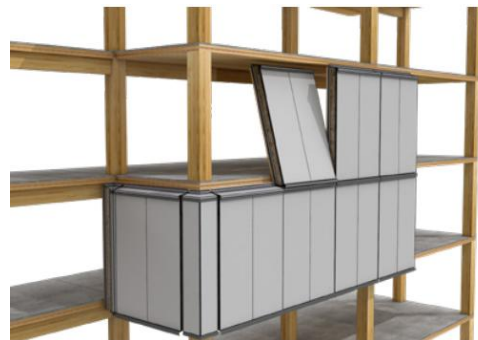
Εικόνα 64. «Διάγραμμα τοποθέτησης προκατασκευασμένων πάνελ μικρού μεγέθους»
