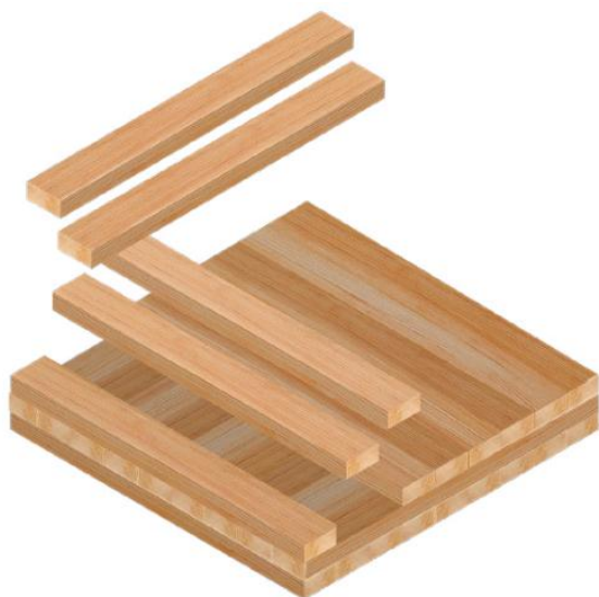
Εικόνα 46. «Διάγραμμα σύνθεσης CLT πανέλων»
