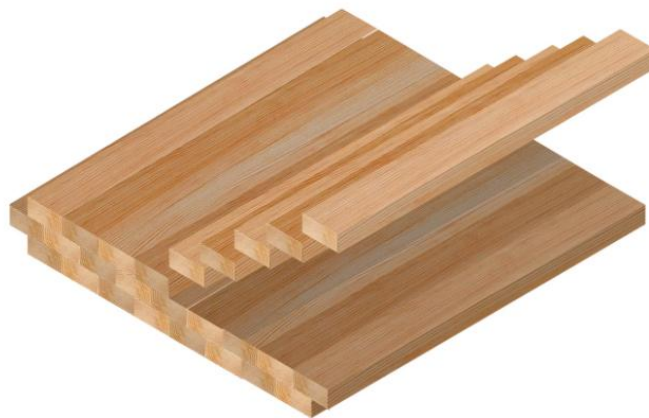
Εικόνα 49. «Διάγραμμα σύνδεσης Glulam πανέλων»
