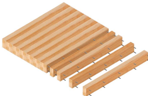
Εικόνα 48. «Διάγραμμα σύνδεσης NLT πανέλων»
