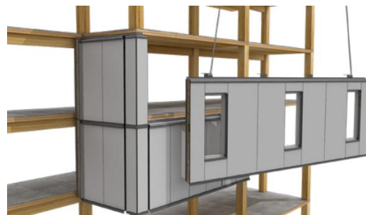
Εικόνα 65. «Διάγραμμα τοποθέτησης προκατασκευασμένων πάνελ μεγάλου μεγέθους»
