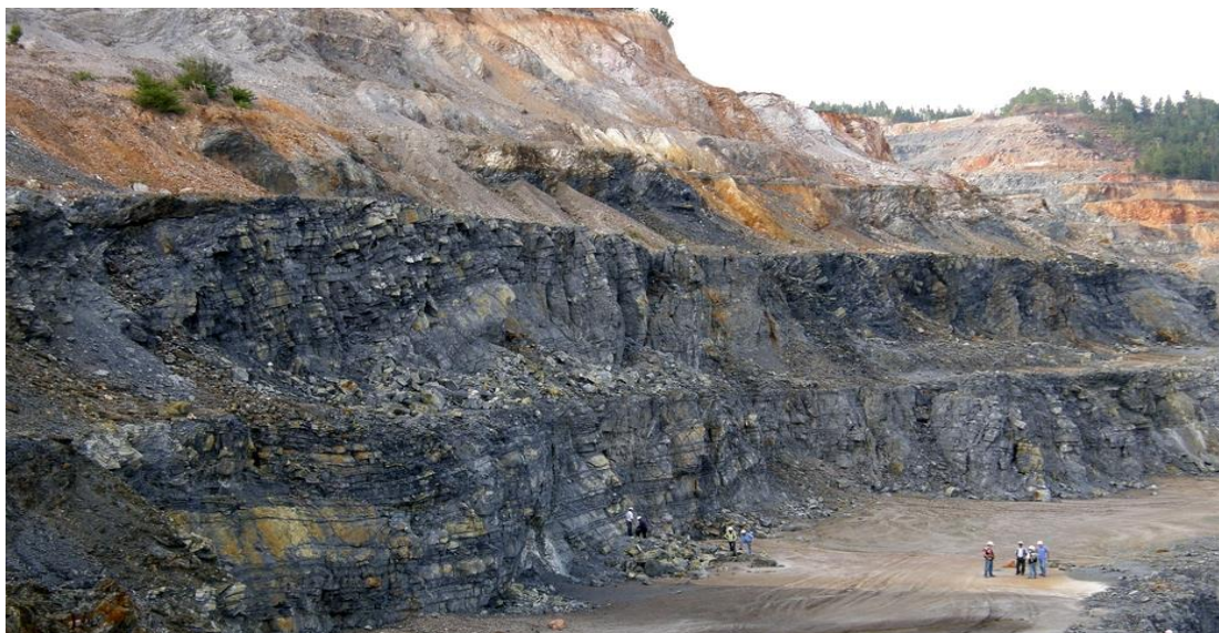
Σχήμα 3.2: Βαθμίδες υπαίθριας εκμετάλλευσης του μεταλλείου Cerro de Maimón (Perilya Limited, n.d.).
