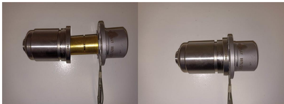
Σχήμα 4.14: Συνδεσμολογία ακροφυσίου και δακτυλίου
