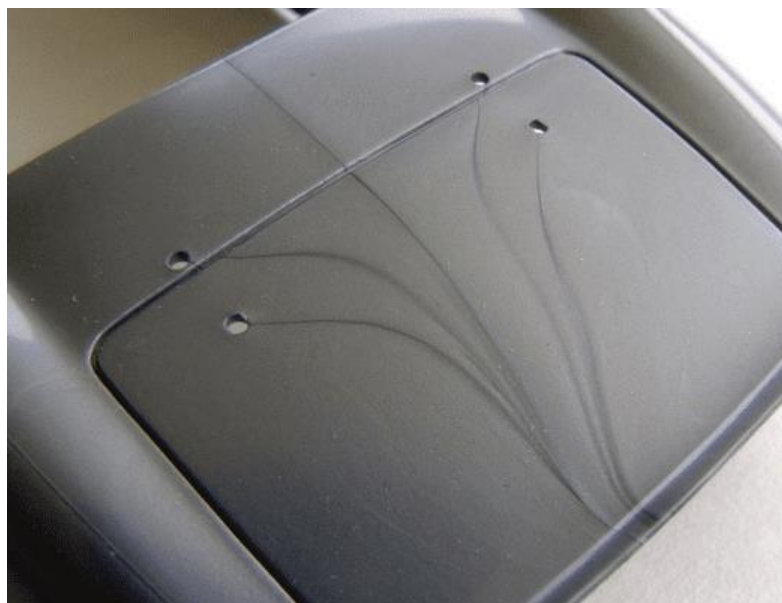
Σχήμα 4.21: Σημάδια / Γραμμές ροής σε επιφάνεια τελικού προϊόντος [15]
