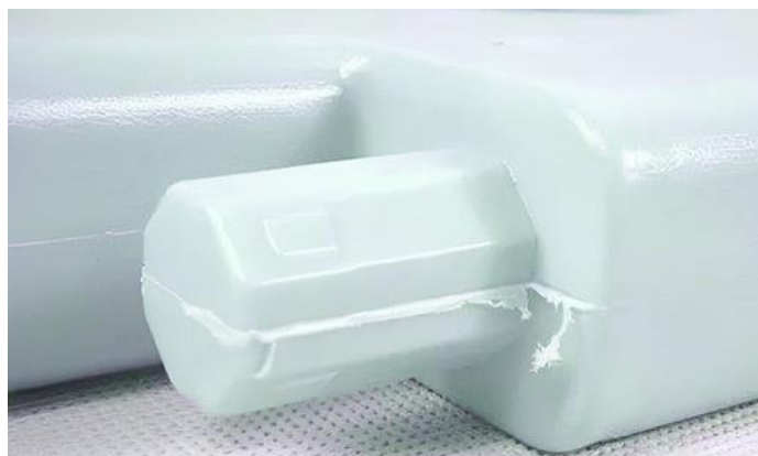
Σχήμα 4.27: Προέκταμα σε προϊόν έγχυσης στην περιοχή της γραμμής διαχωρισμού λόγω ανεπαρκούς δύναμης σύσφιξης [21]
