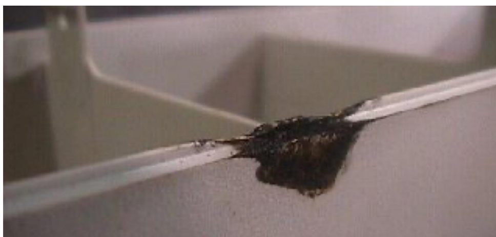
Σχήμα 4.29: Σημάδια καύσης στην εξωτερική επιφάνεια ενός τελικού προϊόντος έγχυσης λόγω αυτανάφλεξης του πολυμερούς τήγματος κατά την φάση της συμπίεσης [23]
