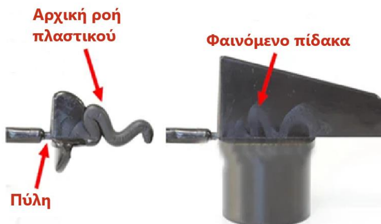
Σχήμα 4.26: Προϊόν έγχυσης με φολιδωτό μοτίβο στην εξωτερική επιφάνεια λόγω ανάπτυξης του φαινομένου πίδακα κατά την έγχυση [20]
