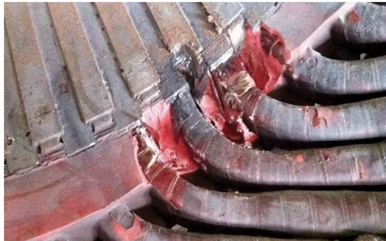
Εικόνα 3.2: Ηλεκτρική διάσπαση στη μόνωση ηλεκτρικής μηχανής [34]
