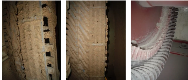
Εικόνα 3.3: Μόλυνση από σκόνη (εικόνα α και β) και τσιμέντο (εικόνα γ)
