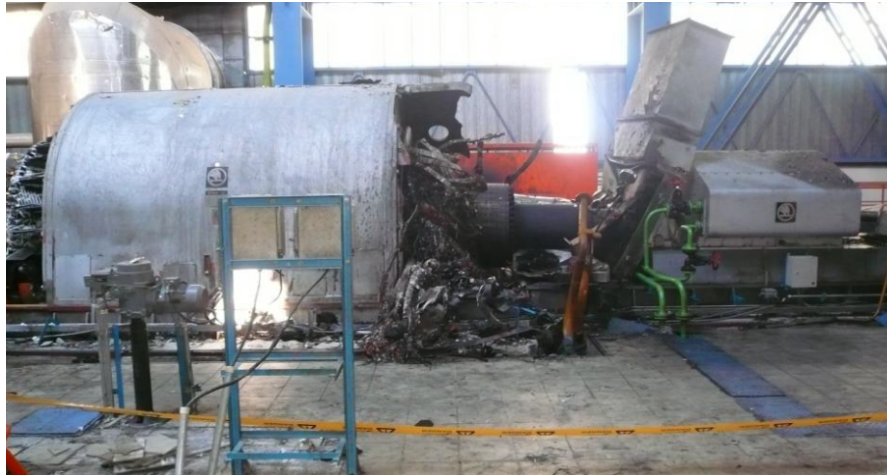
Εικόνα 3.7: Λανθασμένος χειρισμός σύμπλεξης φορτίου [41]
