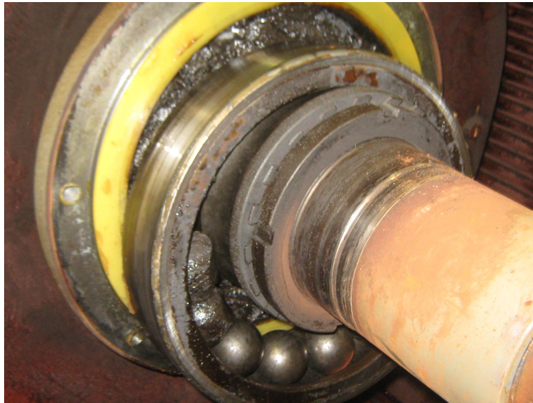
Εικόνα 3.4: Αστοχία ρουλεμάν ηλεκτρικής μηχανής λόγω μηχανικής καταπόνησης [37]
