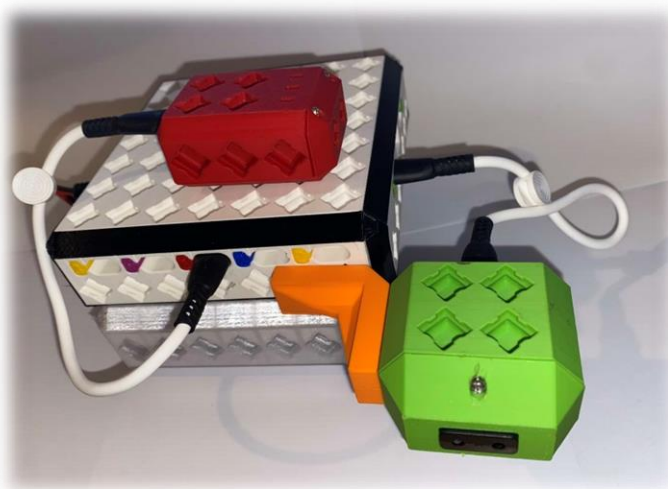
Εικόνα 7-8. Απεικόνιση διάταξης για ανίχνευση εμποδίου.
