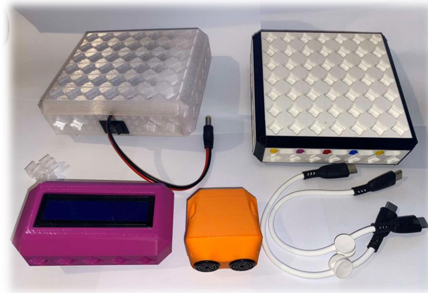
Εικόνα 7-4. Αποσυναρμολογημένη διάταξη για εμφάνιση δεδομένων στην οθόνη.
