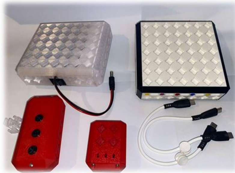
Εικόνα 7-1. Αποσυναρμολογημένη διάταξη ρυθμιζόμενων LED από κουμπιά.
