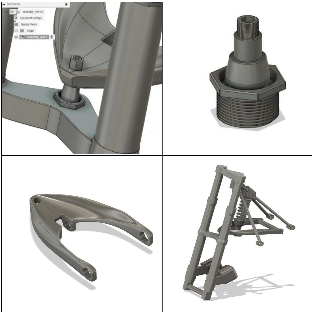
Εικόνα 23 : Το ολοκληρωμένο σύστημα Telelever κάτω δεξιά, πάνω δεξιά και αριστερά το Ball Joint και κάτω αριστερά το διπλό ψαλίδι A-ARM.
