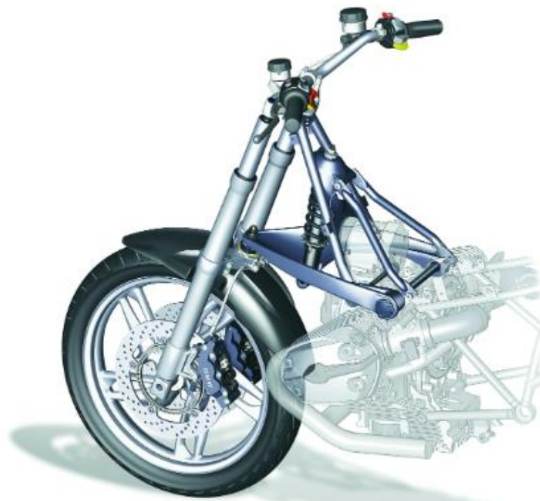
Εικόνα 14: Εμπρόσθιο σύστημα ανάρτησης Telelever. (Πηγή : Wikipedia)
