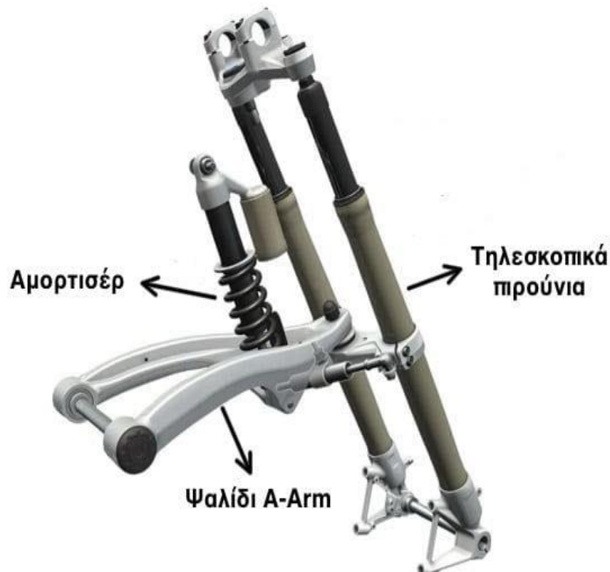
Εικόνα 15 : Τα διάφορα μέρη που απαρτίζουν το σύστημα Telelever. (Πηγή : bmwMotorradHellas.com )
