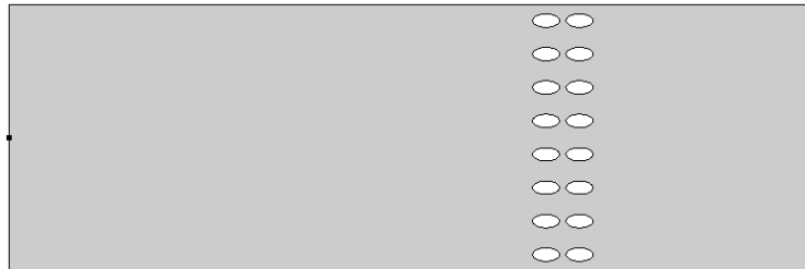
Εικόνα 22. Δομή με ελλειπτικούς οριζόντιους σκεδαστές
