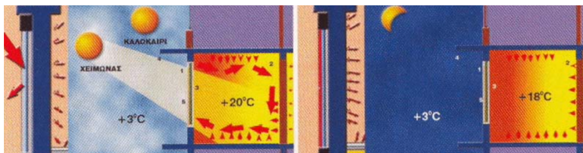
Εικόνα 6: Έμμεση αποθήκευση της ηλιακής ενέργειας σε τοίχο μάζας, κατά την διάρκεια της μέρας και της νύχτας (ΔΙΠΕ κ.α, 2000)
