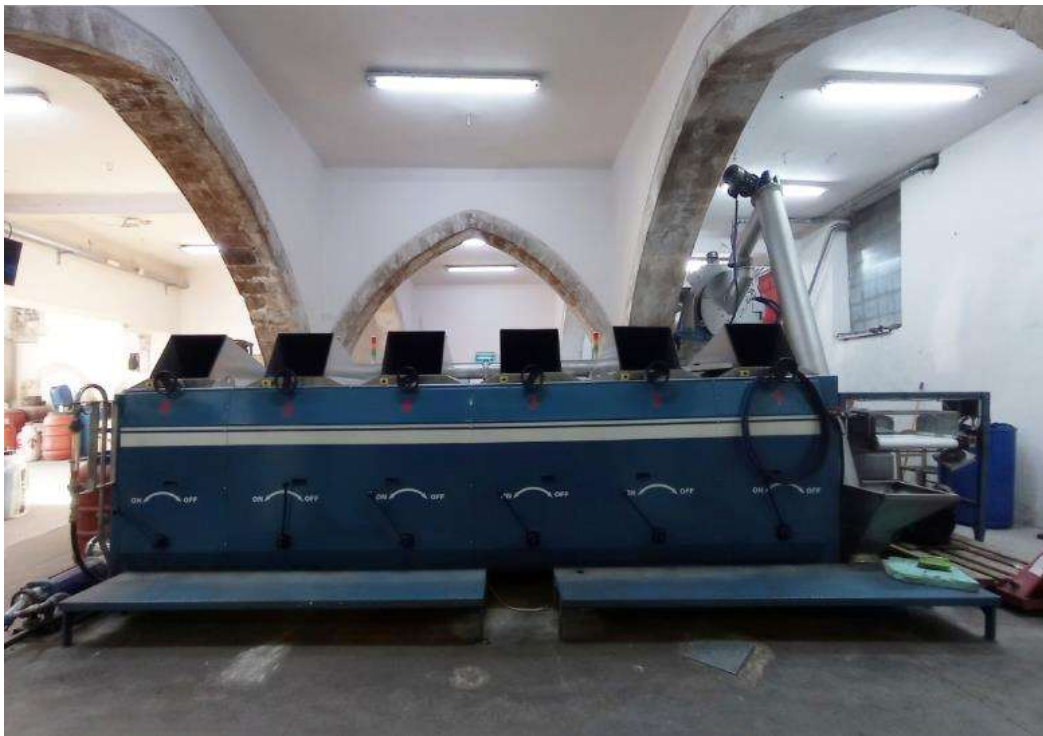
Εικόνα 62. Η μονάδα ζύμωσης τοποθετημένη ακριβώς στο κέντρο του καννάβου που σχηματίζουν οι λίθινες καμάρες (Λήψη: Γ Λιόφραγος). Είναι ευδιάκριτη η ασυμβατότητα του περιεχομένου με το κέλυφος και η προσπάθεια για να προσαρμοστεί η γραμμή παραγωγής στο τύπου του ισογείου.
