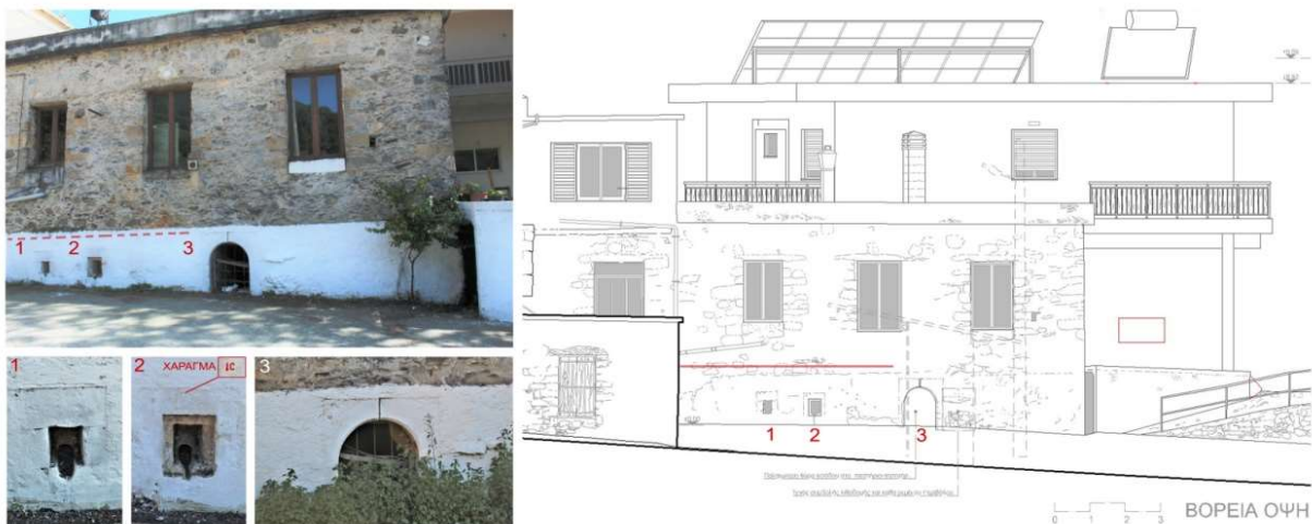
Εικόνα 40. Το καφενείο στη νότια πτέρυγα και το υπόγειο. Φαίνονται στο ισόγειο οι απορροές του μούστου που μας οδηγούν στο συμπέρασμα ύπαρξης παλαιότερα, πατητηριού στη πρώτη φάση κατασκευής.
