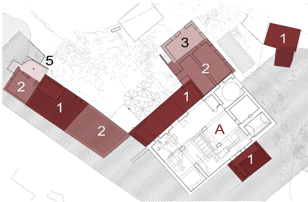
Εικόνα 27. Κάτοψη ισογείου. Κατασκευαστικές φάσεις. Οι σκούρες αποχρώσεις καταδεικνύουν παλαιότερες κατασκευαστικές φάσεις. (Σχεδιασμός Γ. Λιόφαγος).
