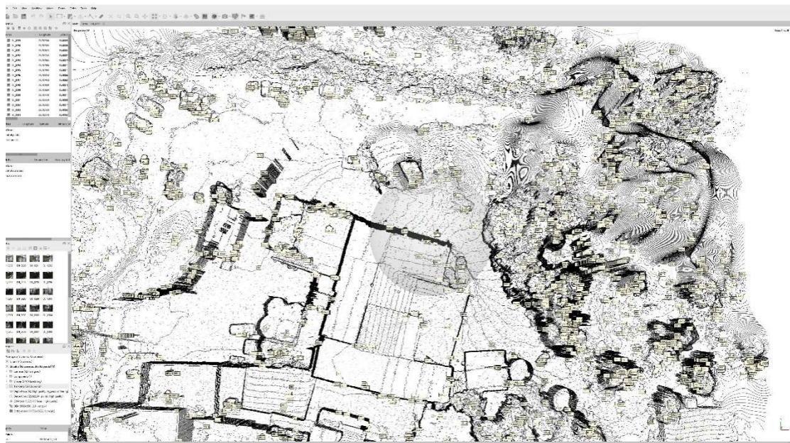
Εικόνα 16. Επεξεργασία μοντέλου μέσω φωτογραφικών λήψεων σε περιβάλλον Agi Soft. Παραγωγή υψομετρικών γραμμών ανά 20 εκατοστά. Επεξεργασία (Γ. Λιόφαγος).
