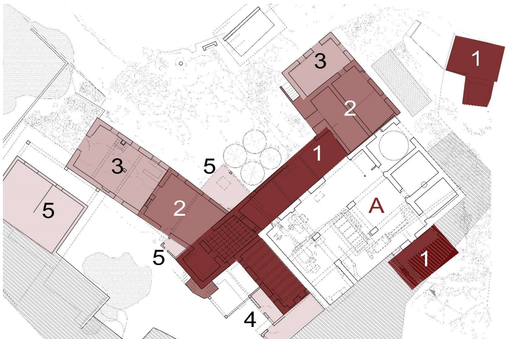
Εικόνα 28. Κάτοψη ορόφου. Κατασκευαστικές φάσεις. (Σχεδιασμός Γ. Λιόφαγος).
