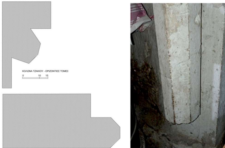
Εικόνα 49. Οριζόντιες τομές πεσσών δευτερεύουσας εστίας. (Αποτύπωση και φωτογραφίες: Γ. Λιόφαγος).
