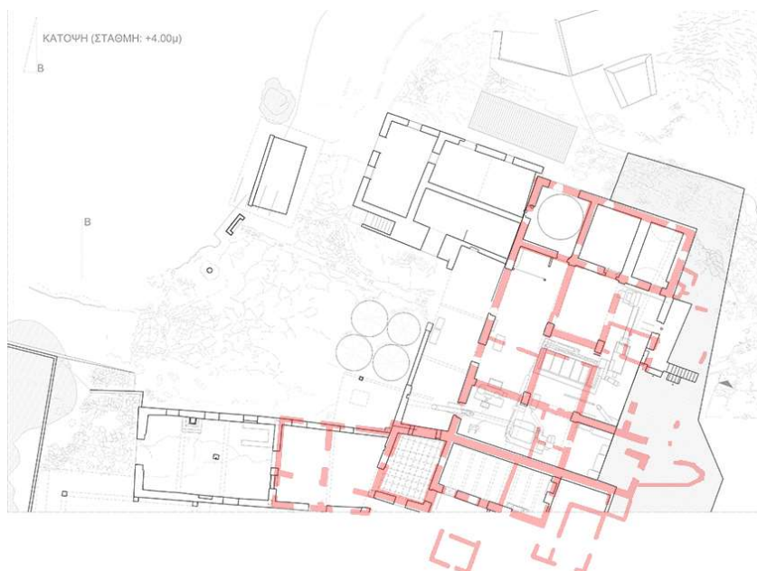
Εικόνα 35. Κάτοψη ισογείου με τις εγκαταστάσεις του ελαιοτριβείου. Τα ερυθρά ίχνη στη κάτοψη υποδηλώνουν χαράξεις των τοιχοποιιών του ορόφου με τη σημερινή διαρρύθμιση του. Οι χαράξεις ταυτίζονται με τις αντίστοιχες του ισογείου με τους πεσσούς, τα τόξα. (Σχεδιασμός: Γ. Λιόφαγος).
