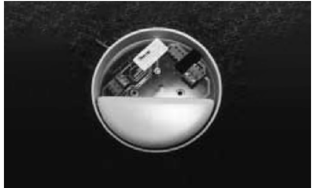
Εικόνα 18: Εσωτερική δομή κρεμαστών φωτιστικών (Barlow et al.,1999,p.66).
