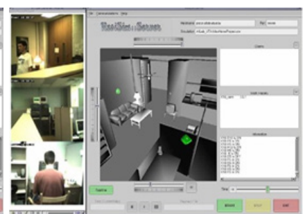
Εικόνα 34: Απεικόνιση συστήματος ResiSim με πράσινες σφαίρες με ενεργοποιημένους αισθητήρες κίνησης (Das & Cook, 2005,p.21).
