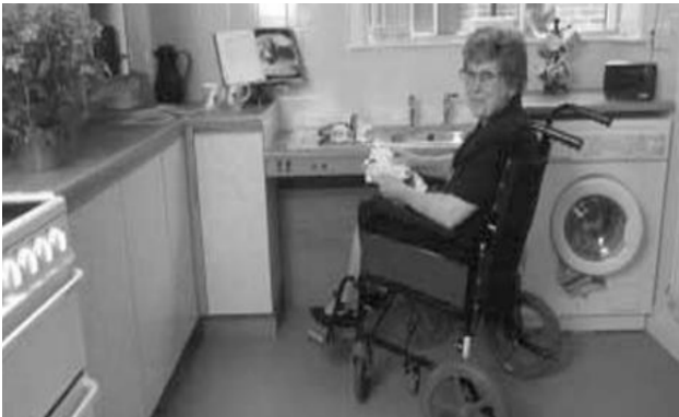
Εικόνα 13: Νεροχύτης σε χαμηλωμένη θέση (Barlow et al.,1999,p.73).
