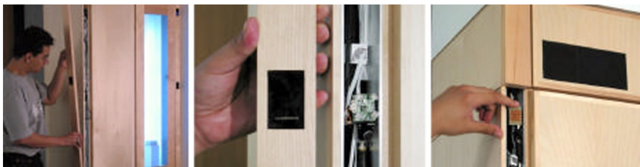
Εικόνα 30: Τοποθέτηση αισθητήρων στην ντουλάπα (Mit-Tiax Place Lab , n.d.,2003,p.5).
