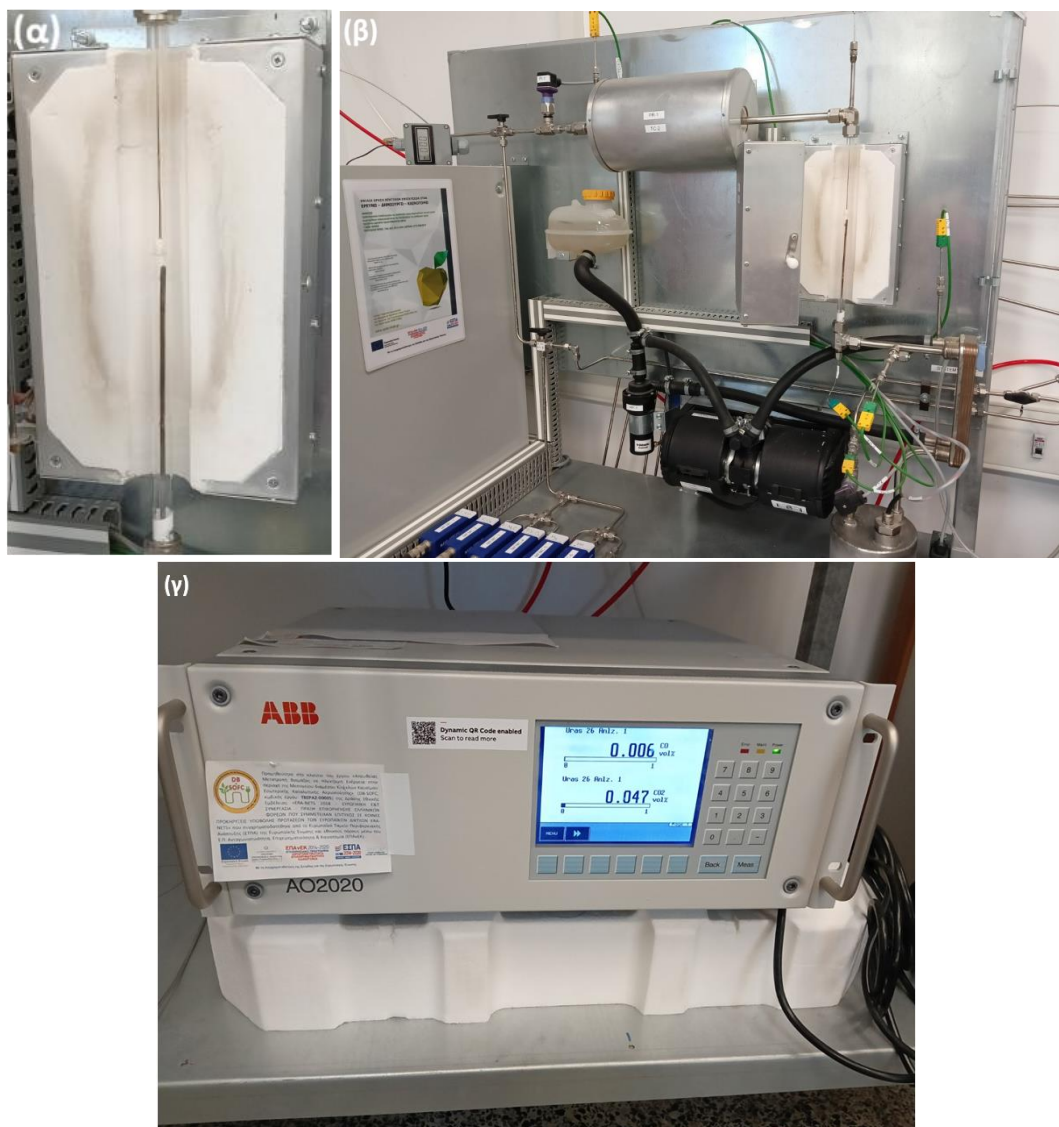
Εικόνα 5. (α) Ο αντιδραστήρας χαλαζία σταθερής κλίνης, (β) η καταλυτική μονάδα δοκιμών και (γ) ο αναλυτής CO (ABB AO2020).
