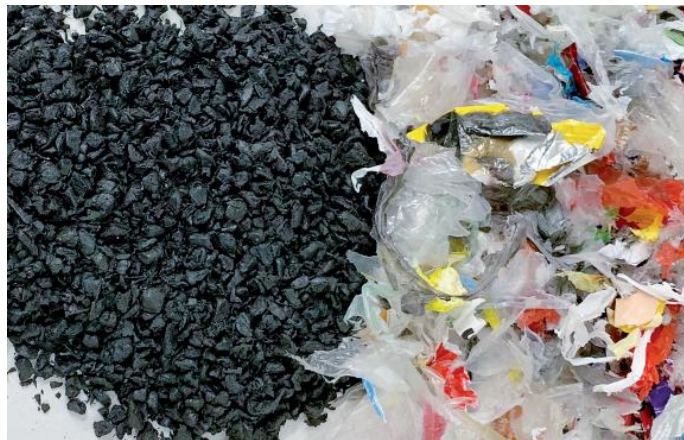
Εικόνα 2.6: Το νέο υλικό που παράγει η Close the Loop για την κατασκευή δρόμων
