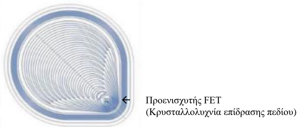
Σχήμα 13: Ανιχνευτής ολίσθησης πυριτίου-σταγόνα (droplet SDD) [104].
