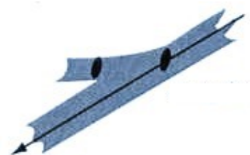
Σχήμα 1.12: Μηχανισμός εναπόθεσης σωματιδίων στο αναπνευστικό σύστημα (αναχαίτιση) (αναπροσαρμοσμένο από Λαζαρίδης, 2010).
