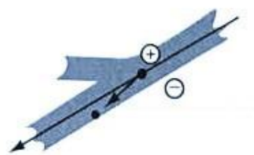
Σχήμα 1.13: Μηχανισμός εναπόθεσης σωματιδίων στο αναπνευστικό σύστημα (ηλεκτροστατική καθίζηση) (αναπροσαρμοσμένο από Λαζαρίδης, 2010).
