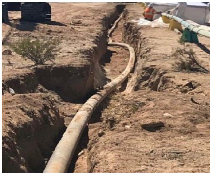
Εικόνα 2.6: Παραμορφωμένο τμήμα χαλύβδινου αγωγού φυσικού αερίου μετά από εκσκαφή σε σημείο διέλευσης ρήγματος. Φωτογραφία από την PG&E.
