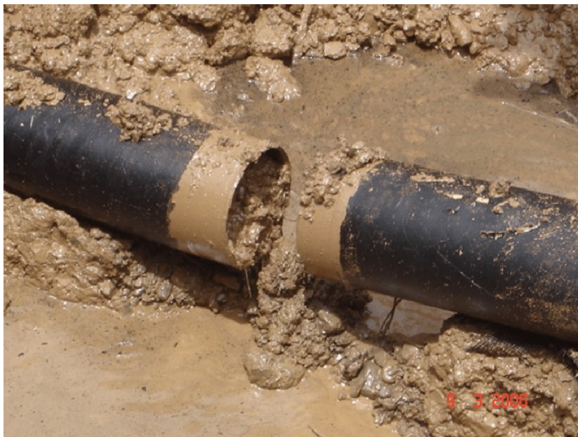
Εικόνα 1.6: Διάρρηξη αγωγού διαμέτρου 14 ιντσών λόγω πλευρικής μετατόπισης 1,5-2 m ύστερα από μετακίνηση προϋπάρχουσας κατολίσθησης (φωτογραφία: E. M. Lee, Απρίλιος 2006).
