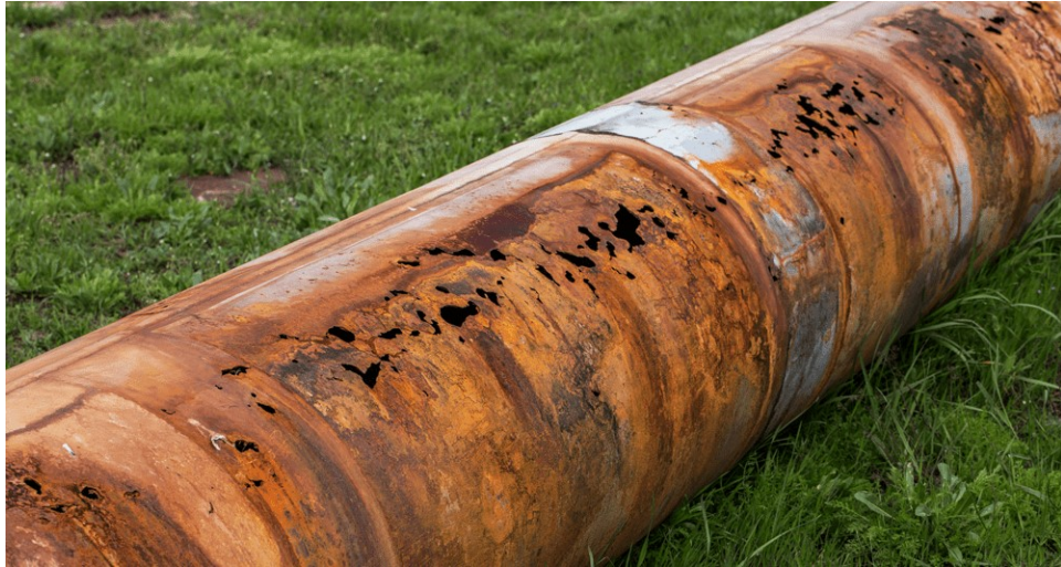
Εικόνα 2.4: Αγωγός που έχει αστοχήσει λόγω διάβρωσης Πηγή: Interplast
