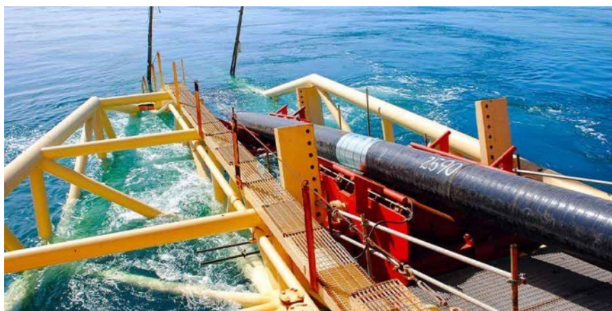
Εικόνα 1.3: Πλοίο, υπεύθυνο για την τοποθέτηση αγωγών φυσικού αερίου στη Μαύρη Θάλασσα. Πηγή: Phmsa
