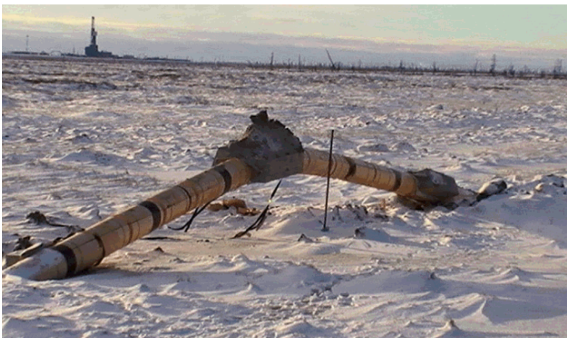
Εικόνα 2.9: Αστοχία μεταλλικού αγωγού λόγω Καθολικού Λυγισμού Πηγή : What is Piping
