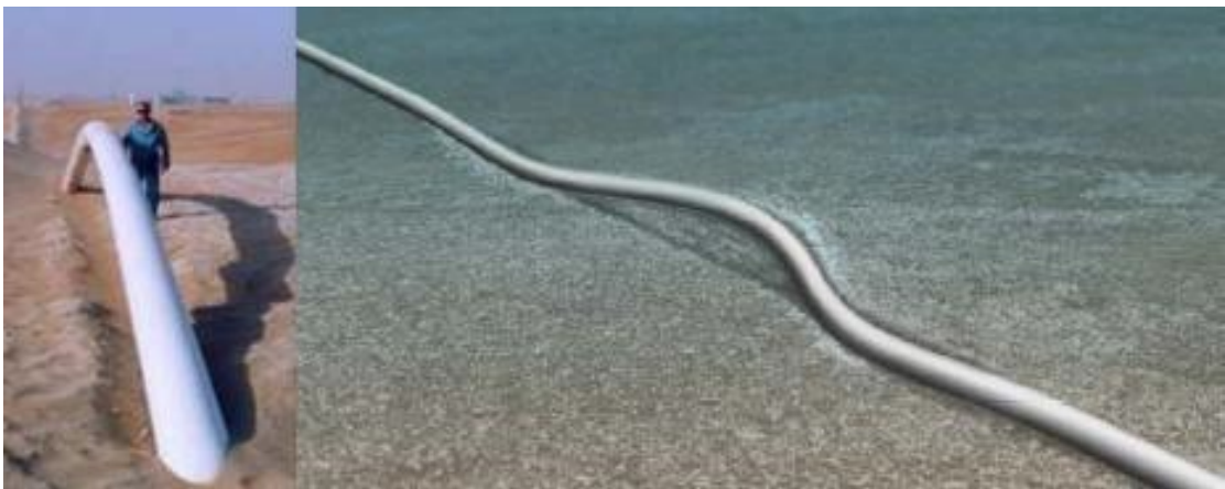
Εικόνα 2.10: Αστοχία αγωγού λόγω Καθολικού Λυγισμού
