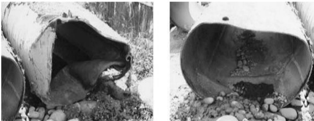
Εικόνα 2.8: Τοπικός Λυγισμός μεταλλικού αγωγού. Πηγή : Takada et al. 2001
