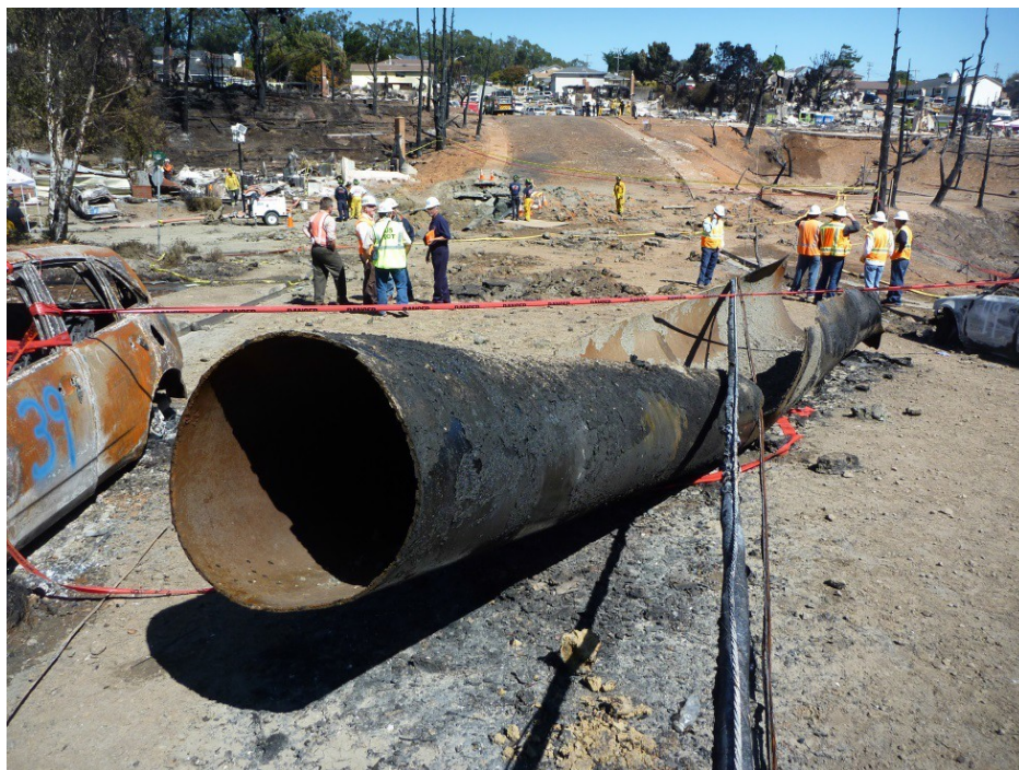
Εικόνα 1.7: Τμήμα του αγωγού του San Bruno που εξερράγη στις 9 Σεπτεμβρίου του 2010. Αιτία της έκρηξης σύμφωνα με το Εθνικό Συμβούλιο Ασφάλειας Μεταφορών ήταν εγκατάσταση ενός υποβαθμισμένου και κακώς συγκολλημένου τμήματος σωλήνα με ορατό ελάττωμα συγκόλλησης. Πηγή : NTSB (National Transportation Safety Board).
