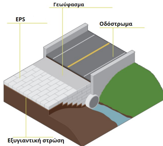
Εικόνα 3.10: Προστασία αγωγού με τη χρήση γεωφωρού EPS (EPS Industry Alliance, 2020).
