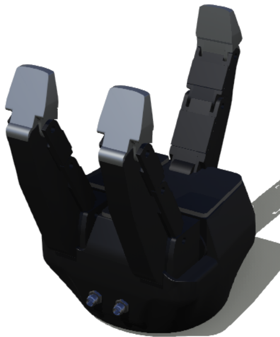
Σχήμα 3.13: 3-Finger Robotiq Adaptive Robot Gripper "node" στο λογισμικό Webots
