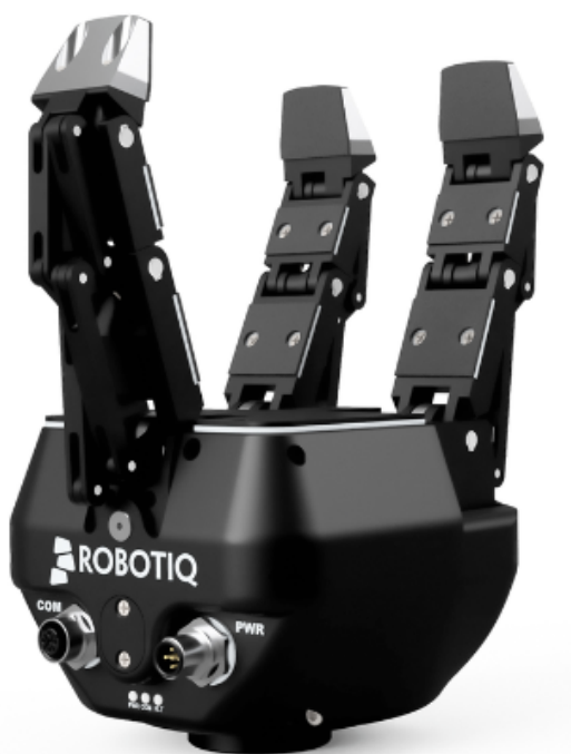
Σχήμα 3.12: 3-Finger Adaptive Robot Gripper της εταιρείας Robotiq.
