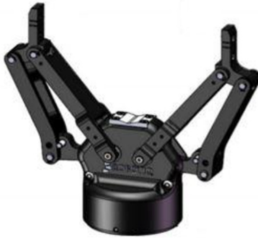
Σχήμα 2.14: Παράδειγμα αρπάγης δύο δαχτύλων
