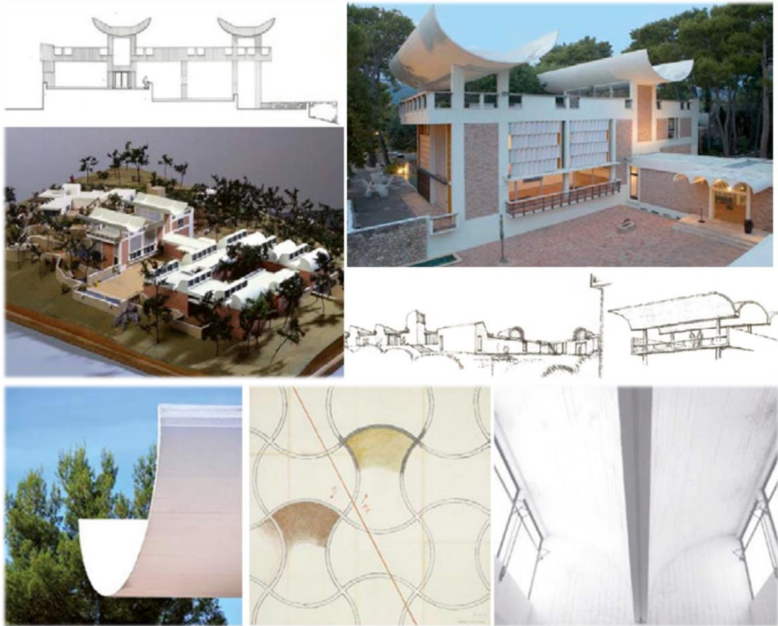
Εικόνα 97: Σχέδια, απόψεις, μακέτα και λεπτομέρειες από το ίδρυμα Maeght από αριστερά προς τα δεξιά μορφή απορροής ομβρίων, σχέδιο των πλακιδίων τετρακότα, εσωτερική άποψη της ημι-κυκλικής μορφής όπου το κάθετο τμήμα λειτουργεί ως φωταγωγός. Πηγή: Ίδρυμα Maeght (Saint-Paul de Vence) (2014), έκθεση με τίτλο Η τέχνη και η αρχιτεκτονική του Josep Lluís Sert για τη συμπλήρωση 50 ετών (1964-2014).
