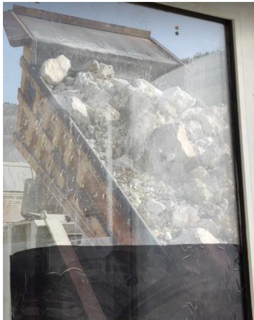
Εικόνα 4.7. Απόθεση υλικού στον θραυστήρα από το χωματουργικό Caterpillar dumper 773D
