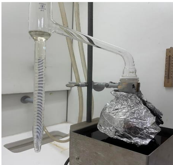
Εικόνα 6 : Διάταξη μεθόδου κλασματικής απόσταξης ASTM D95-05
