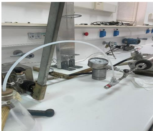
Εικόνα 22 : Συνδεσμολογία της διάταξης με σωλήνες που κατέληγαν στο περιβάλλον
