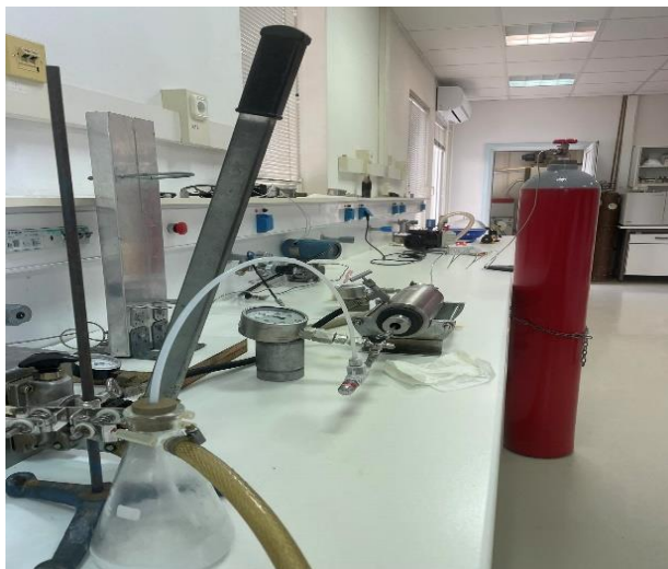
Εικόνα 21 : Φιάλη διοξειδίου του άνθρακα συνδεμένη με τη διάταξη
