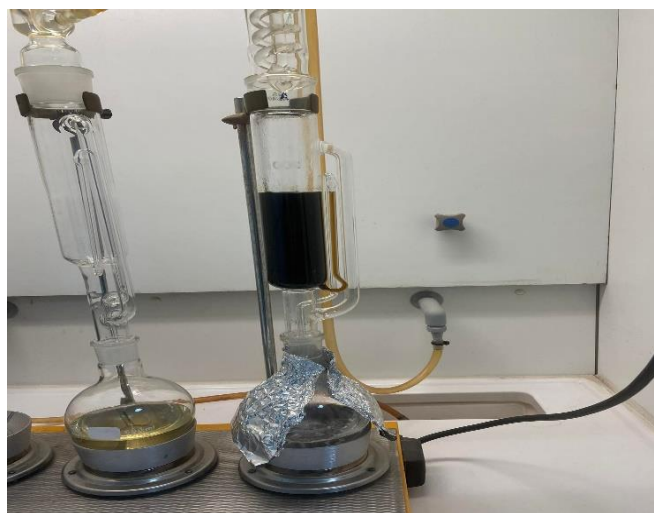
Εικόνα 9 : Διάταξη εκχύλισης Soxhlet που χρησιμοποιήθηκε στην πειραματική διαδικασία
