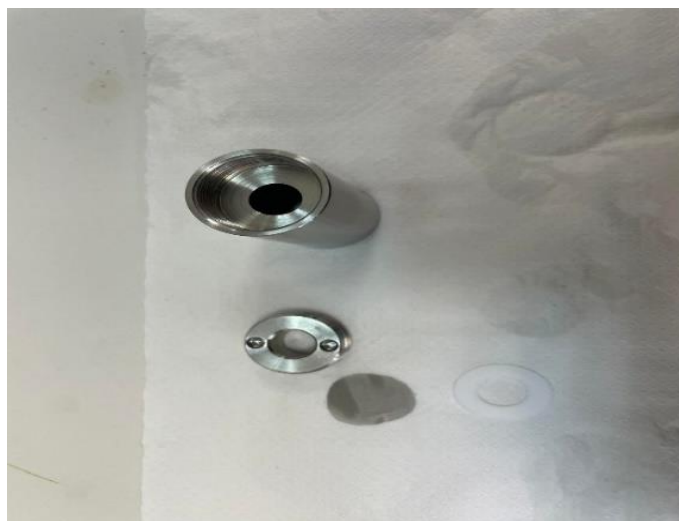
Εικόνα 14 : Κυλινδρικός από ανοξείδωτο χάλυβα δειγματοφορέας με φίλτρο και δακτυλίδι στεγάνωσης
