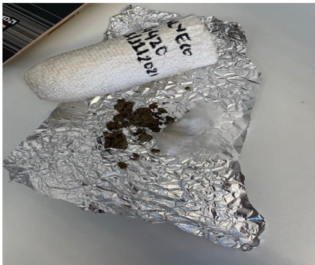
Εικόνα 10 : Ποσότητα δείγματος μετά την εκχύλιση Soxhlet, υαλοβάμβακας και φίλτρο υποδοχής δείγματος(ηθμός)
